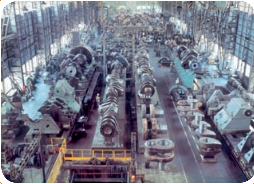
در این کارخانه اجزای میل لنگ کشتی روی هم منطبق می شوند.
