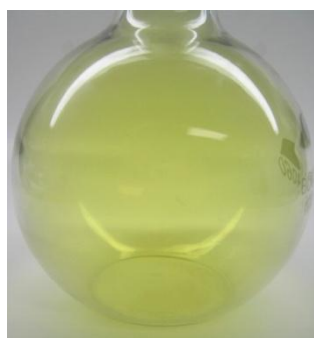
عنصر کلر به شکل گاز زرد رنگ بوده و از مولکولهای Cl_2 تشکیل شده است.
