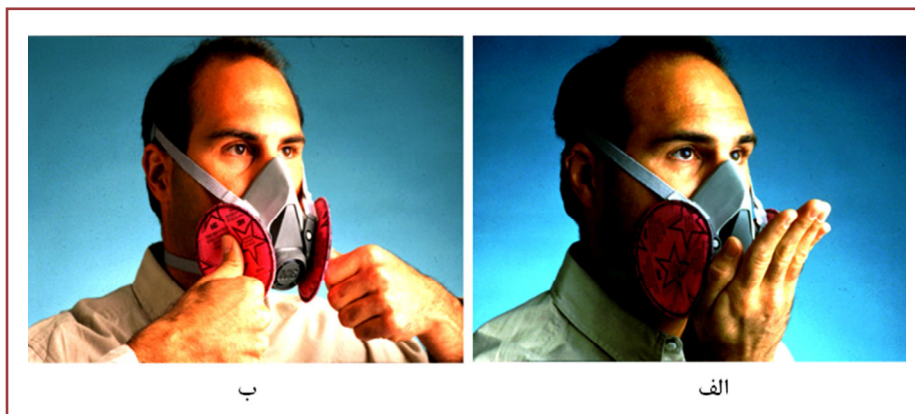
شکل ۳۸ - آزمایش کیپ بودن رئسپراتور. الف- آزمایش فشار مثبت ب- آزمایش فشار منفی
