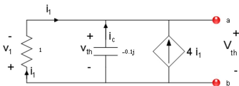
در این مدار داریم  $i_{sc} = 0$  و  $v_{th} = 0$  زیرا هنگامی که مدار فاقد منابع مستقل باشد، ولتاژ و جریان تمام شاخه‌ها برابر صفر است.
