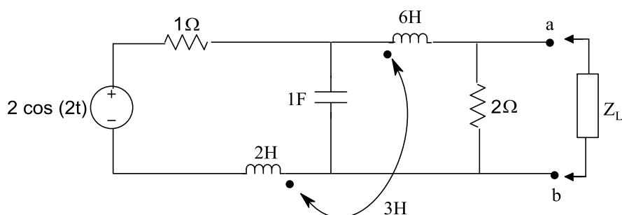
الف) رسم مدار در حوزه فازور و استفاده از منبع تست برای به دست آوردن معادل تونن:
