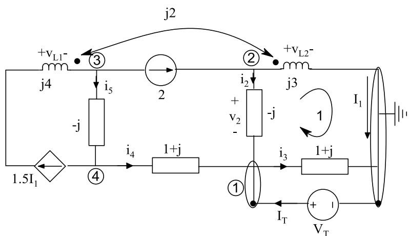
$$\text{Kvl 1: } v_{L2} - v_T - v_2 = 0 \rightarrow 3ji_1 - 2j(1/5i_1) - v_T + ji_2 = 0 \rightarrow i_2 = -jv_T \quad (1)$$
