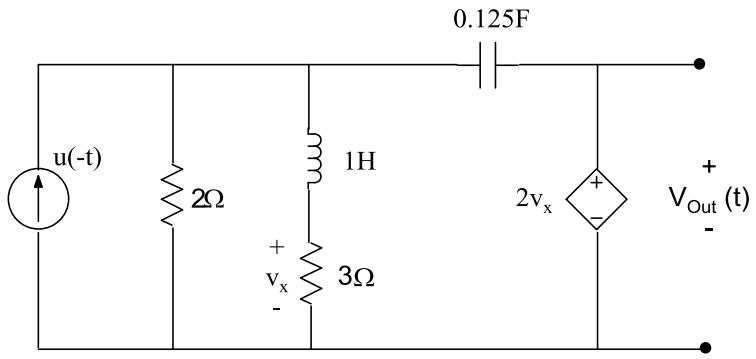
با دقت در شکل درمی‌یابیم که برای یافتن  $V_{\text{Out}}(t)$  کافی است  $v_x$  را محاسبه کرده و دو برابر نماییم.
