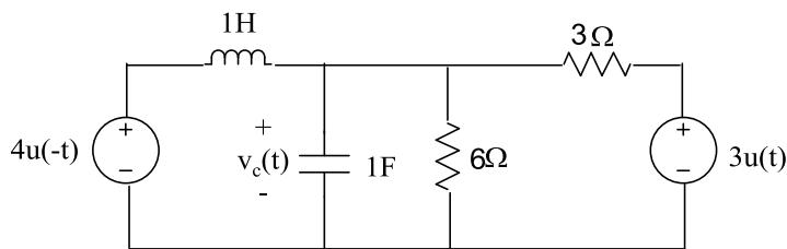
رسم مدار در  $t \geq 0$
