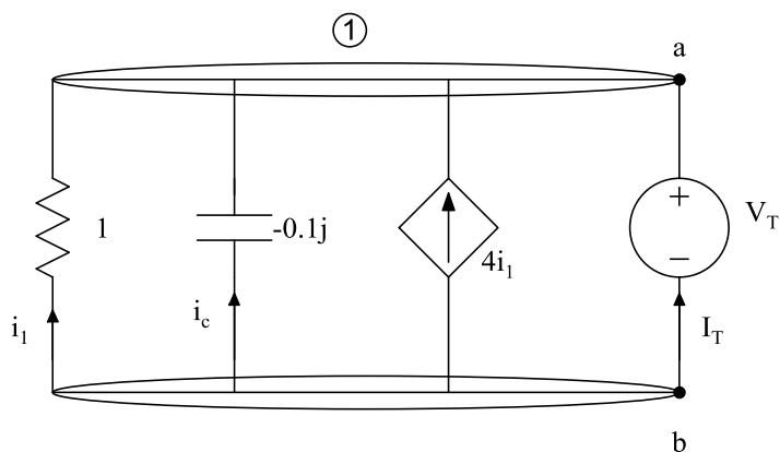
$$KCL \text{ at } b: i_1 + i_c + 4i_1 + I_T = 0 \rightarrow -5V_T - 10jV_T + I_T = 0 \rightarrow (5 + 10j)V_T = I_T$$
