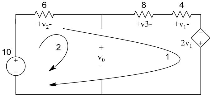
$$KVL \ 1: \ -v_2 + v_3 + v_1 - 2v_1 - 10 = 0 \rightarrow -v_2 + v_3 - v_1 - 10 = 0$$
