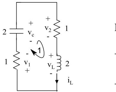
$$\text{Kvl 1: } v_2 + v_L + v_1 - v_c = 0$$
