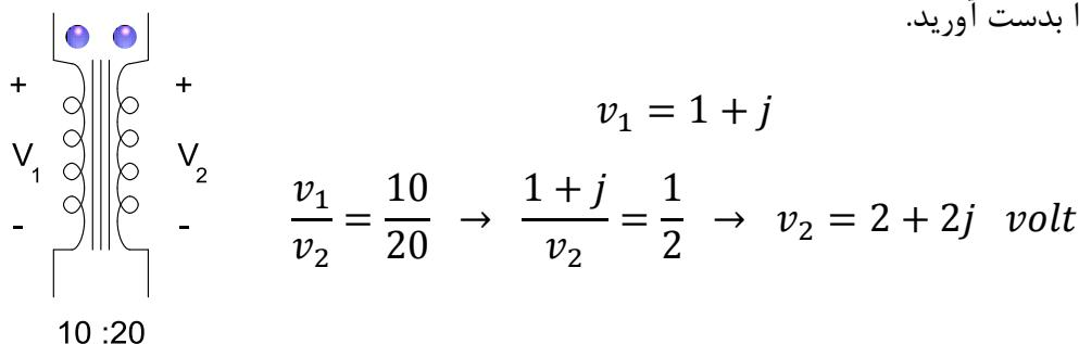
با توجه به این مثال مشخص است که به جای استفاده از تعداد دور سیم پیچ  $n_1$  و  $n_2$  می‌توان از نسبت دور سیم پیچ‌ها استفاده کرد.
