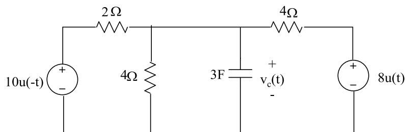
رسم مدار در  $t \geq 0$
