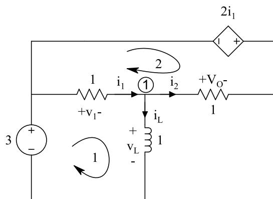
$$\text{Kcl 1: } i_1 = i_L + i_2 \rightarrow v_1 = \int_{-\infty}^t v_L(t) dt + V_O \quad (1)$$
