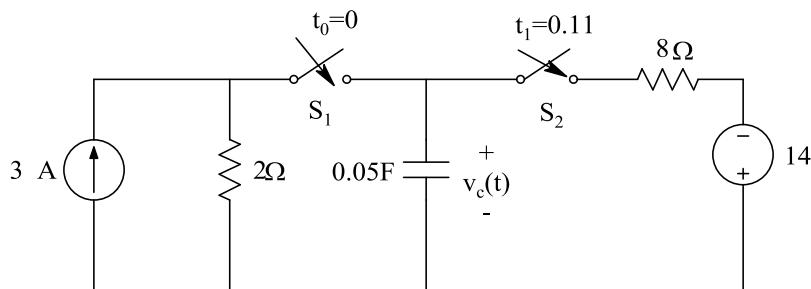
وقتی در مدار کلید داریم بسته به اینکه چه زمانی کلیدها عمل می‌کنند مدارهای مختلفی وجود دارد. در این مدار، یک مدار در بازه  $0 \leq t < 0/11$  وجود دارد که فقط کلید  $S_1$  بسته می‌شود و کلید  $S_2$  باز است و در بازه  $t \geq 0/11$  مدار دیگری وجود دارد بنابراین باید دو مدار را حل کرد.
