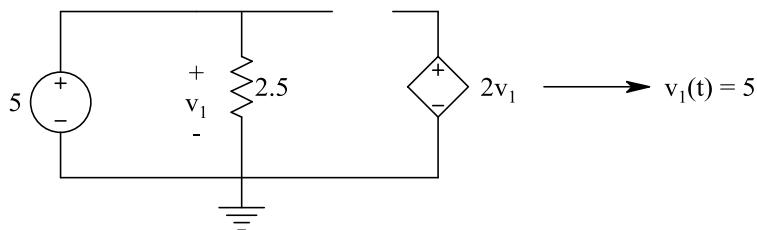
رسم مدار در حالت فازور با  $\omega_2 = 5$
