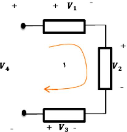
$$\text{kvl 1: } v_1 + v_2 - v_3 - v_4 = 0$$
