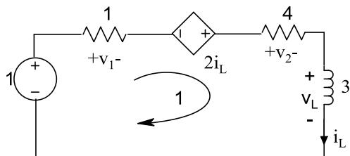
$$KVL 1: v_1 - 2i_L + v_2 + v_L - 1 = 0$$
