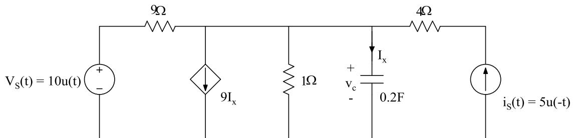
رسم مدار در  $t \geq 0$
