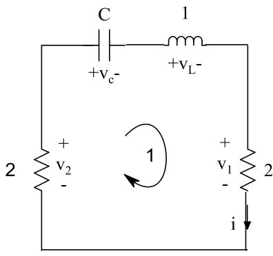
$$\text{Kvl 1: } v_c + v_L + v_1 - v_2 = 0$$
