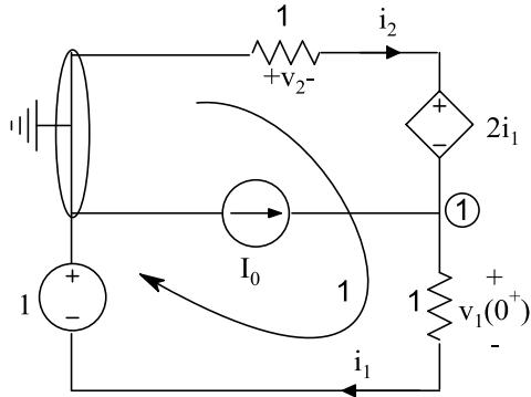
$$KCL 1: i_2 + I_0 = i_1 \rightarrow v_2 + I_0 = v_1(0^+) \quad (1)$$
