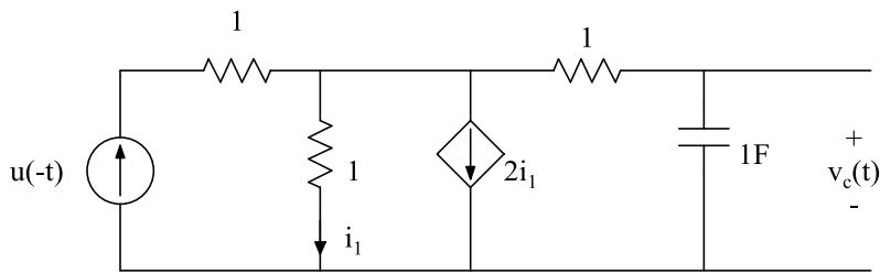
رسم مدار در  $t \geq 0$
