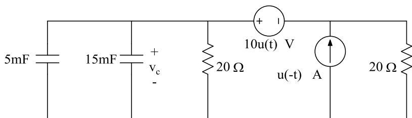
رسم مدار در  $t \geq 0$
