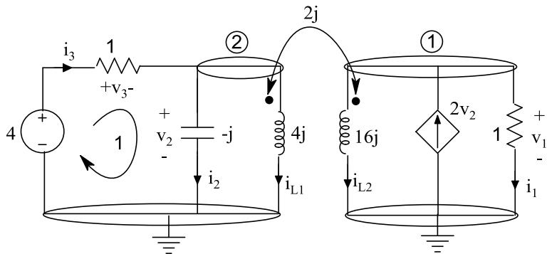
مشاهده می‌شود در مدار شکل فوق دو مدار، مجزا از هم هستند که روی هم اثر تزویج دارند بنابراین هنگام نوشتن رابطه KCL باید برای هر کدام یک گره مبنا در نظر گرفت.
