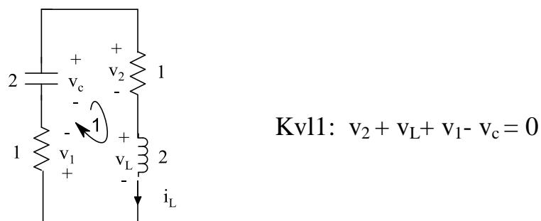
$$\rightarrow i_L + 2 \frac{di_L}{dt} + i_L - \left( -\frac{1}{2} \int_{-\infty}^t i_L(t) dt \right) = 0$$
