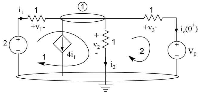
$$\text{Kcl 1: } i_1 = 4i_1 + i_2 + i_c(0^+) \rightarrow 3i_1 + i_2 + i_c(0^+) = 0 \quad (1)$$
