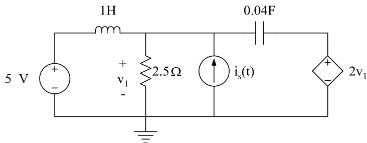
رسم مدار در حالت فازور با  $\omega_1=0$
