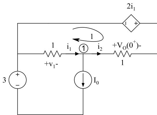
$$KCL 1: i_1 = I_0 + i_2 \rightarrow v_1 = I_0 + V_o(0^+) \quad (1)$$
