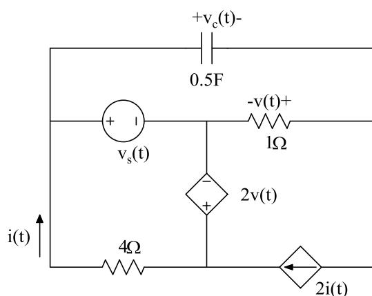
$t \geq 0$  رسم مدار در
