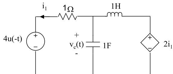
رسم مدار در  $t \geq 0$
