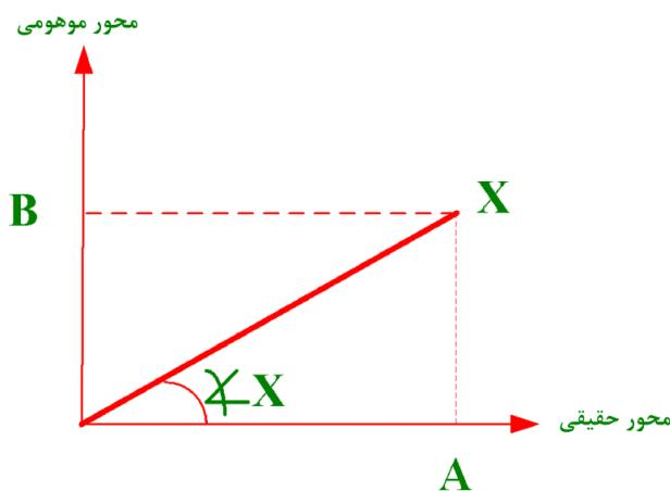
اگر بخواهیم  $Z$  را در دستگاه قطبی بنویسیم باید در شکل فوق با توجه به  $|Z|$  و  $\angle Z$ ، روابط مربوطه را به صورت زیر بنویسیم:
