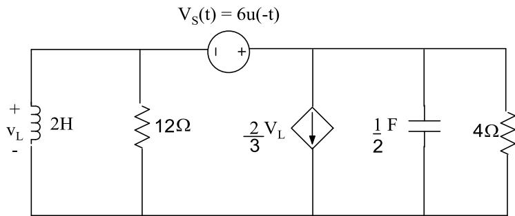
رسم مدار در  $t \geq 0$
