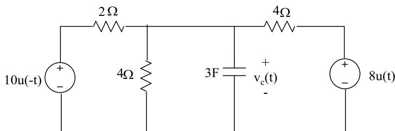
رسم مدار در  $t \geq 0$
