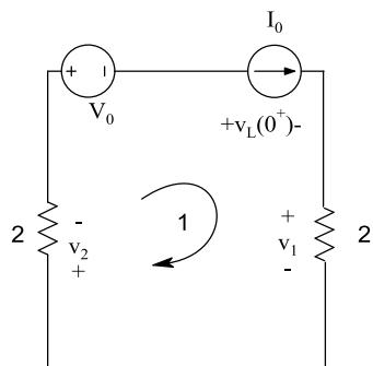
$$KVL 1: V_0 + v_L(0^+) + v_1 + v_2 = 0$$
