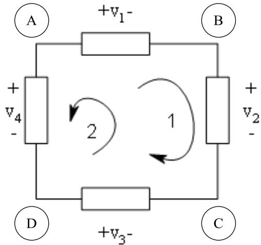
$$\text{KVL ABCDA} = \text{KVL 1: } v_1 + v_2 - v_3 - v_4 = 0$$
