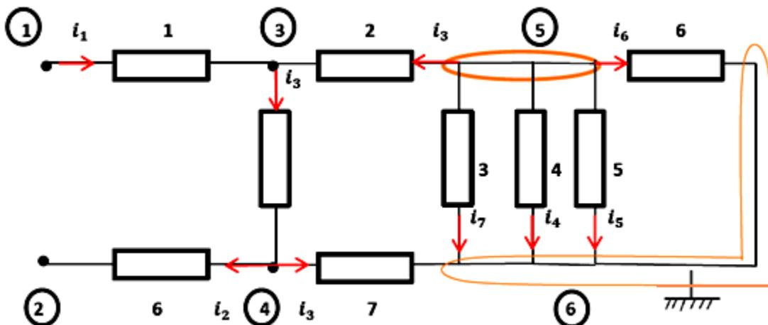
$$\text{Kcl 5: } i_3 + i_4 + i_5 + i_6 + i_7 = 0$$
