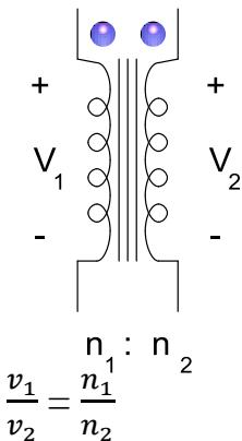
برای ترانس رو به رو رابطه ولتاژ سمت چپ و سمت راست ترانس به صورت زیر است:
