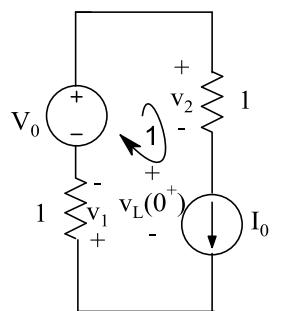
$$\text{Kvl 1: } v_2 + v_L(0^+) + v_1 - V_0 = 0$$
