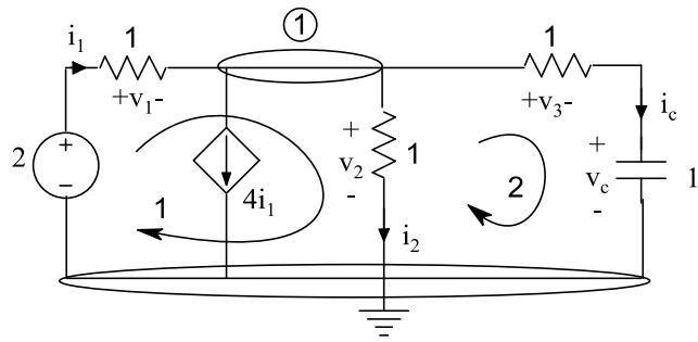
$$\text{Kcl 1: } i_1 = 4i_1 + i_2 + i_c \rightarrow 3i_1 + i_2 + i_c = 0 \quad (1)$$
