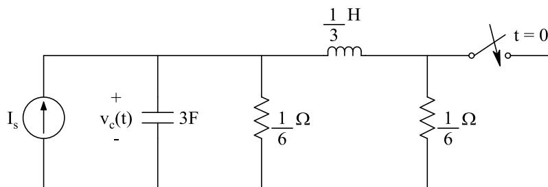
رسم مدار در  $t \geq 0$
