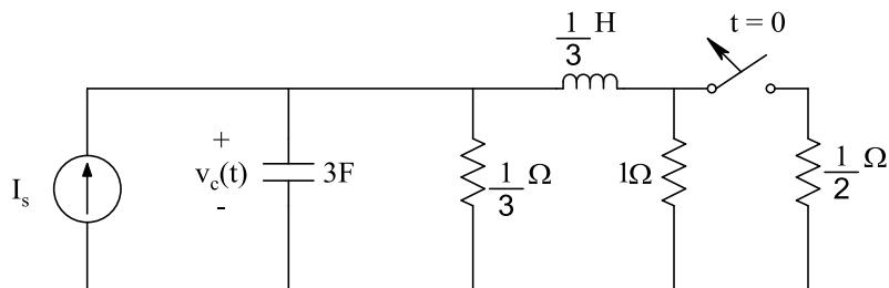
رسم مدار در  $t \geq 0$
