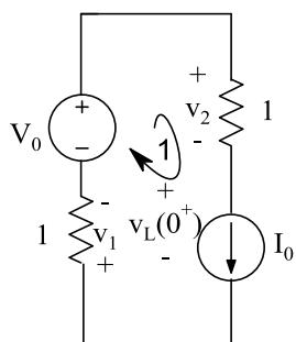
$$\text{Kvl 1: } v_2 + v_L(0^+) + v_1 - V_0 = 0$$
