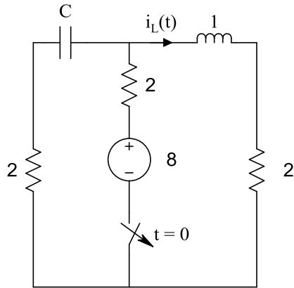
رسم مدار در  $t \geq 0$
