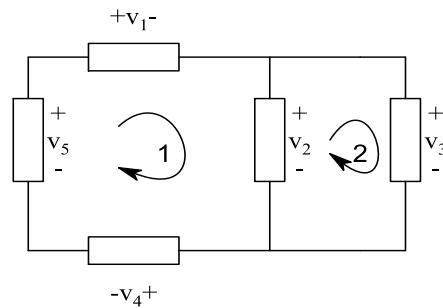
$$\text{KVL 1: } V_1 + V_2 + V_4 - V_5 = 0$$
