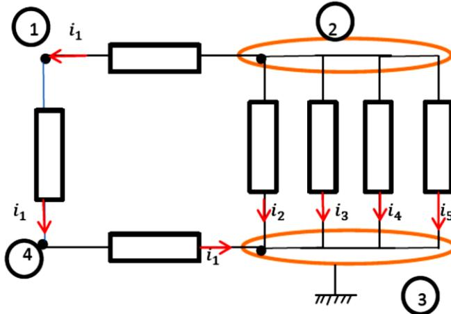
$$KCl 2 : \quad i_1 + i_2 + i_3 + i_4 + i_5 = 0$$
