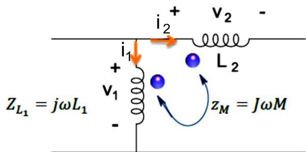
اثر تزویج فقط در هنگام نوشتمن رابطه ولتاژ برای سلفهای تزویج مشخص می‌شود که برای شکل فوق به صورت زیر است:
