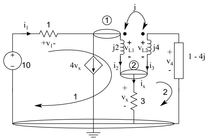
$$\text{KCl 1: } i_1 = 4v_x + i_2 \rightarrow i_1 = 12i_x + i_2 \quad (1)$$
