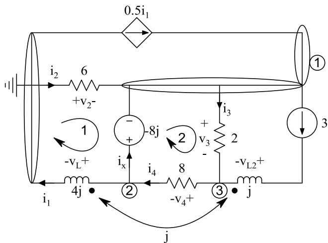
$$\text{Kcl 1: } 0/5i_1 + i_2 + i_x = i_3 + 3 \quad (1)$$
