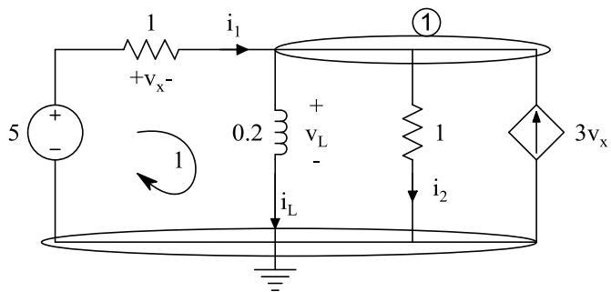
$$\text{Kcl 1: } i_1 + 3v_x = i_2 + i_L \rightarrow i_1 + 3i_1 = i_2 + i_L \rightarrow 4i_1 = i_2 + i_L \quad (1)$$
