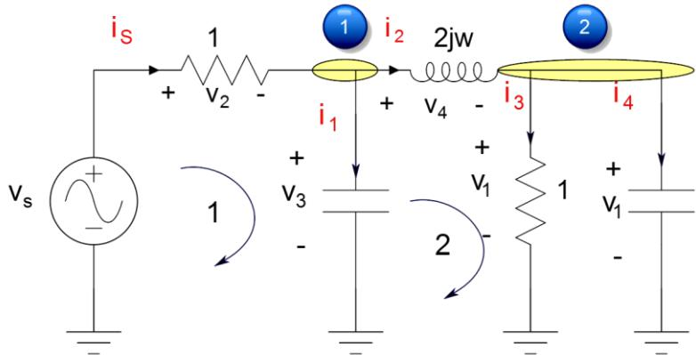
$$kcl \ 1: \quad i_s = i_1 + i_2 \quad \rightarrow \ v_2 = j\omega v_3 + \frac{v_4}{2j\omega} \quad (1)$$
