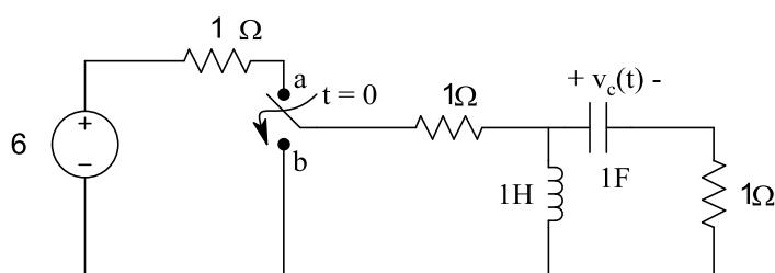
رسم مدار در  $t \geq 0$
