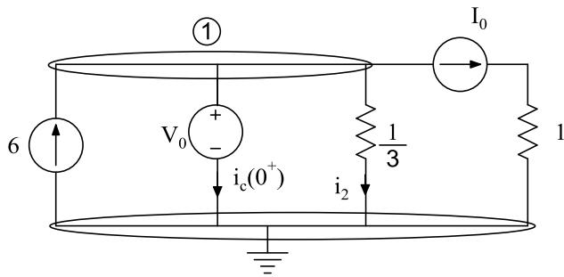
$$\text{Kcl 1: } I_0 + i_2 + i_c(0^+) = 6 \rightarrow i_c(0^+) = 6 - I_0 - 3V_0$$
