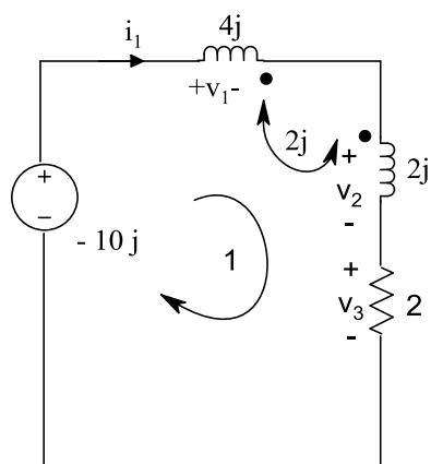
$$KVL 1: v_1 + v_2 + v_3 + 10j = 0$$
