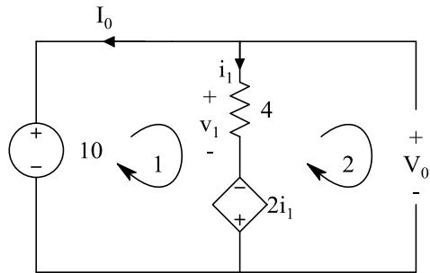
$$Kvl 1: v_1 - 2i_1 - 10 = 0 \rightarrow 4i_1 - 2i_1 - 10 = 0 \rightarrow 2i_1 = 10 \rightarrow i_1 = 5$$
