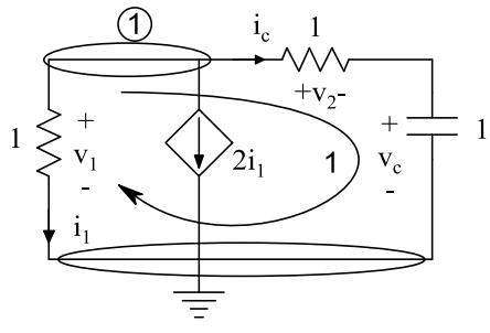
$$\text{Kcl 1: } i_1 + 2i_1 + i_c = 0 \rightarrow 3i_1 + i_c = 0$$
