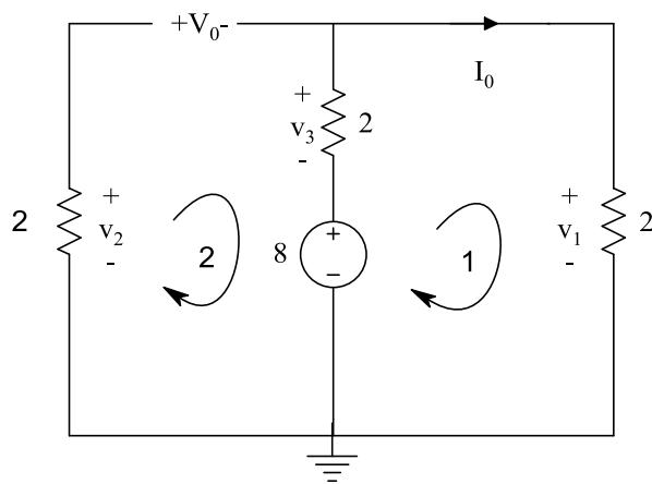
$$\text{Kvl 1: } v_1 - 8 - v_3 = 0 \rightarrow 2I_0 - 8 + 2I_0 = 0 \rightarrow I_0 = 2$$
