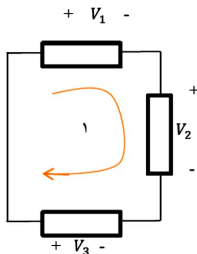
$$\text{Kvl 1: } v_1 + v_2 - v_3 = 0$$
