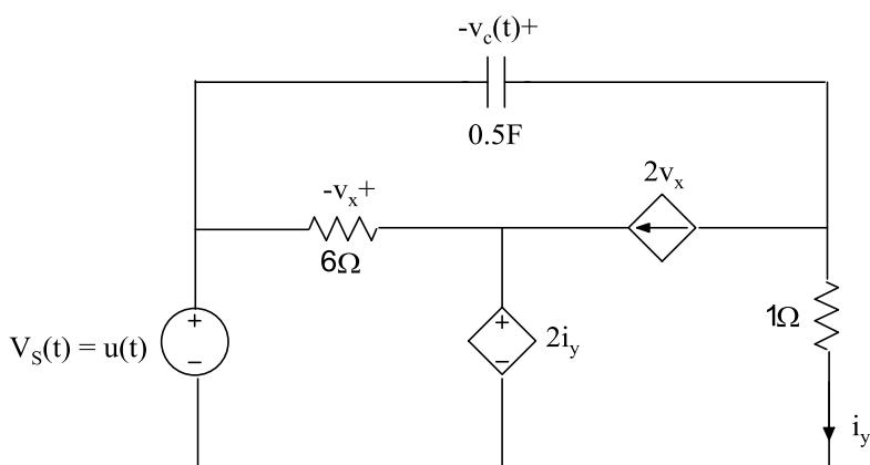
رسم مدار در  $t \geq 0$
