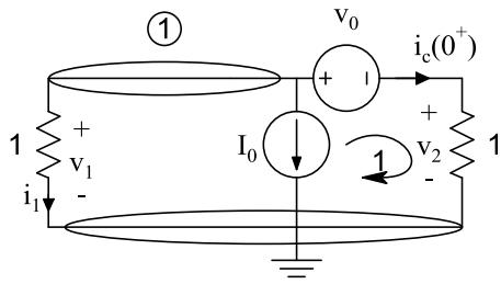
$$\text{Kcl 1: } i_1 + I_0 + i_c(0^+) = 0 \rightarrow i_c(0^+) = -i_1 - I_0 \quad (1)$$
