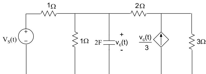
رسم مدار در  $t \geq 0$
