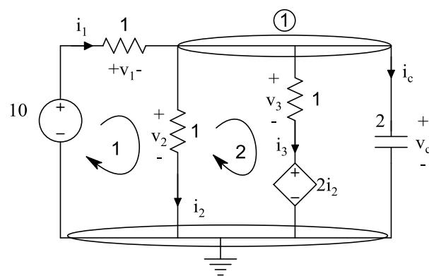
$$\text{Kcl 1: } i_1 = i_2 + i_3 + i_c \quad (1)$$
