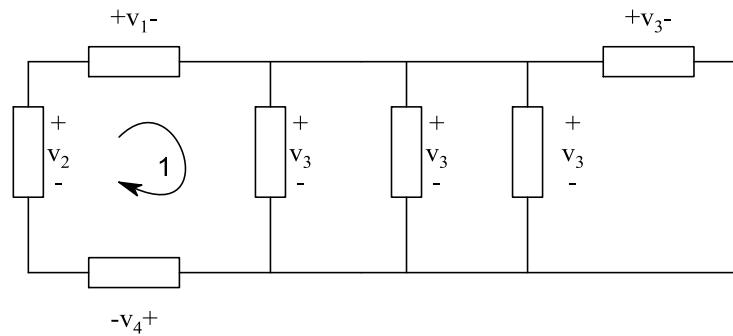
$$\text{KVL 1: } V_1 + V_3 + V_4 - V_2 = 0$$
