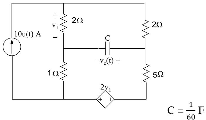
رسم مدار در  $t \geq 0$
