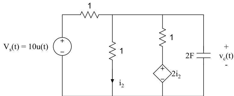
رسم مدار در  $t \geq 0$
