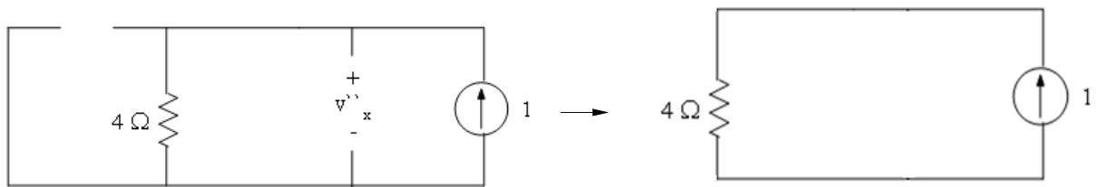
مقادیر  $z_C = \frac{-j}{\omega C} = \infty$  (مدار باز) و  $z_L = j\omega L = 0$  (اتصال کوتاه) نیز در مدار وجود دارد.
