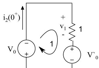
$$KVL 1: v_1 + V'_0 + V_0 = 0 \rightarrow i_2(0^+) = -V'_0 - V_0$$
