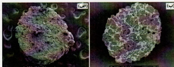
شکل ۴-۱۷- تصویر الف) SE و ب) BSE از سطح مقطع یک ذره. SE برای تصویربردای در حالت توپوگرافی و مورفولوژی و BSE برای کنتراست توزیع فازی مناسب است
