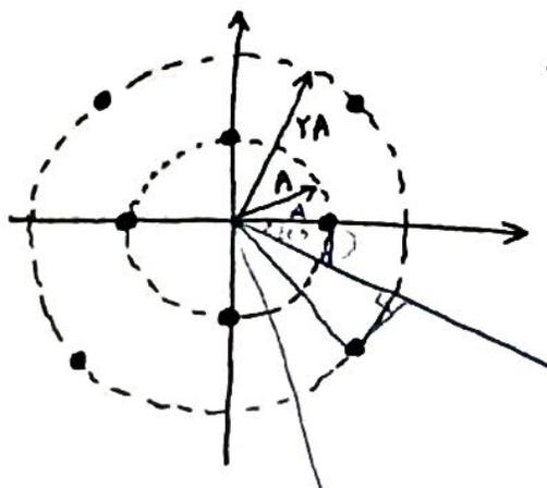
۱- یک سیستم مغایرت دیجیتال از سیگنال  $s_k(t) = A_k \cos(\omega_c t + \phi_k)$  استفاده می کند که  $A_k$  و  $\phi_k$  از روی نقاط منقوله در جدول زیر به دست می آید:
