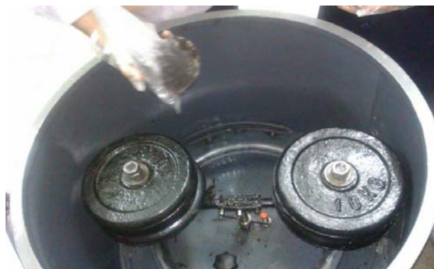
تصویر ۲: دستگاه انجام آزمایش شیارشدگی مسیر چرخ
