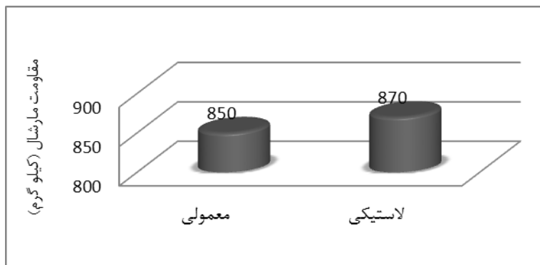
نمودار ۱: مقایسه مقاومت مارشال آسفالت معمولی و لاستیکی (بر حسب Kg)
