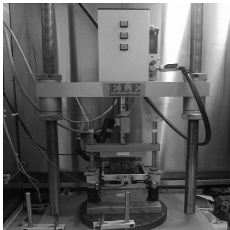
تصویر ۱: دستگاه UTM برای انجام آزمایش مدول برجهندگی
