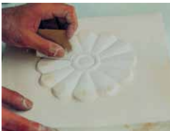
تصویر ۴-ح - پرداختکاری نقش برجسته با سمباده
