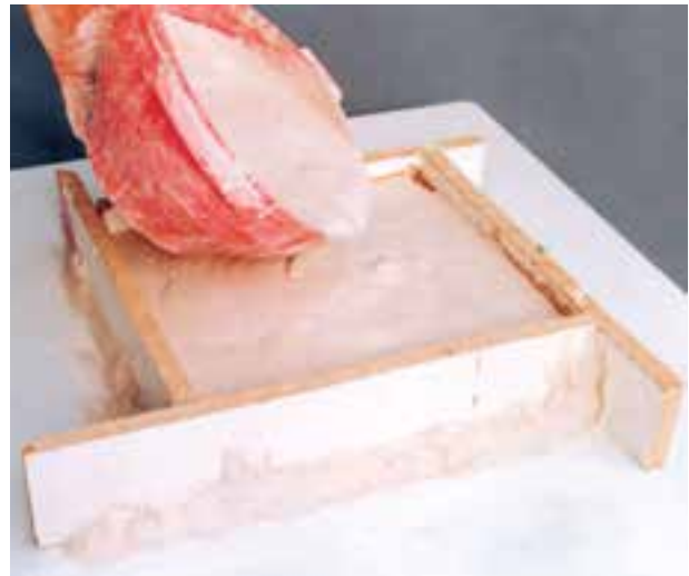
تصویر ۲- ج- ریختن دوغاب گچی روی نمونه
