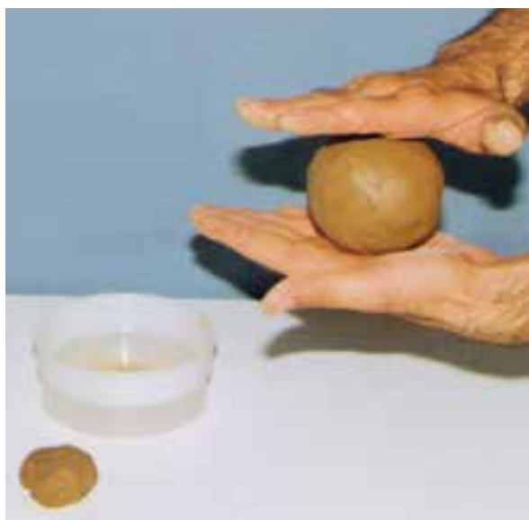
تصویر ۴- الف - ساختن گلوله گلی
