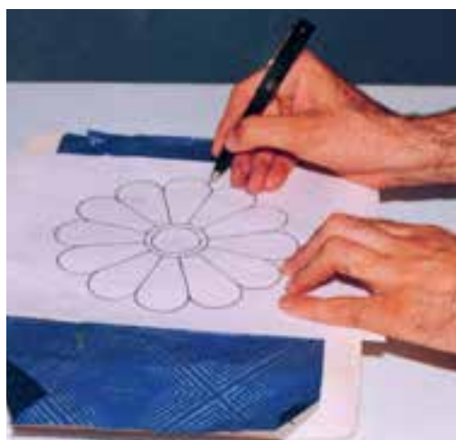
تصویر ۴- الف- انتقال طرح روی لوح گچی
