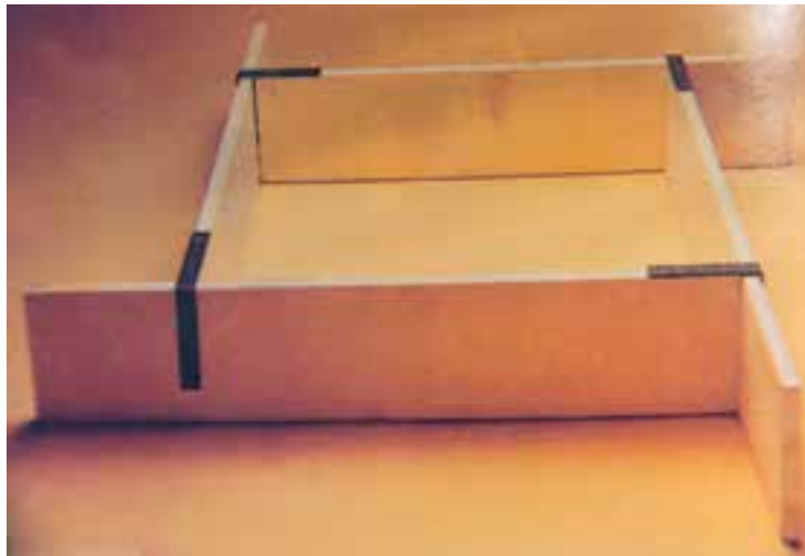
تصویر ۲- الف - ساخت قالب کلی به شکل مکعب
