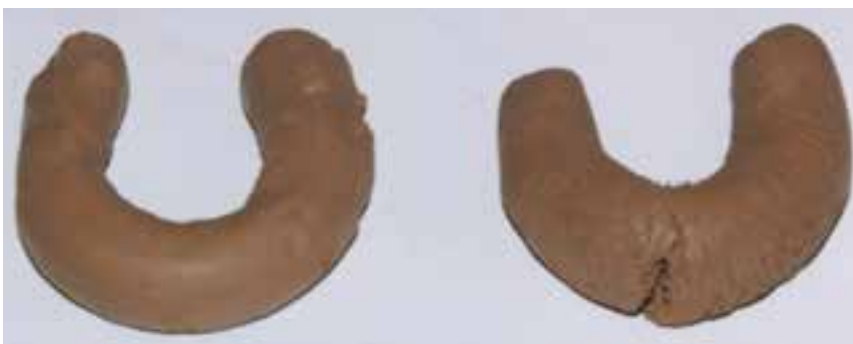
تصویر ۲- هـ- گل با رطوبت کم شکننده است. اما گل با رطوبت مناسب به هر شکلی درمی آید.
