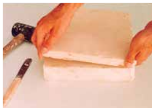
تصویر ۳- ج- برداشتن قالب از روی نمونه
