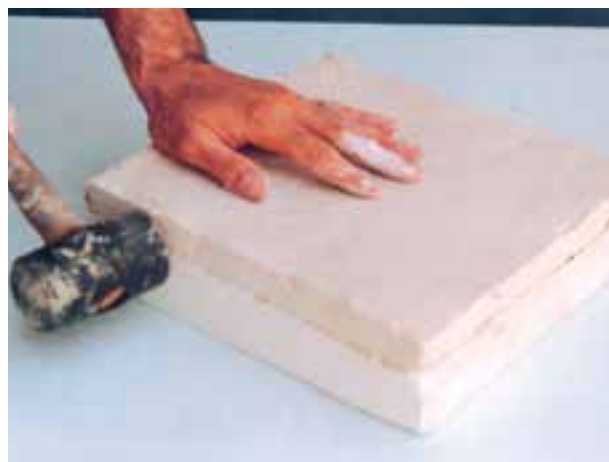
تصویر ۳- الف- جدا کردن نمونه و قالب با ضربه‌های ملایم چکش پلاستیکی
