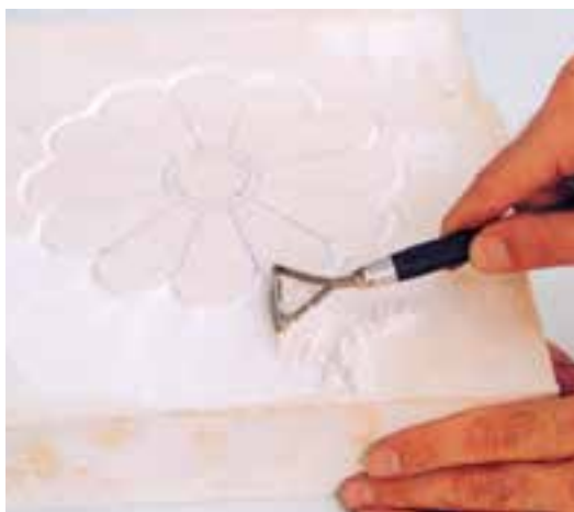
تصویر ۴-د - تراش زمینه برای برجسته شدن طرح
