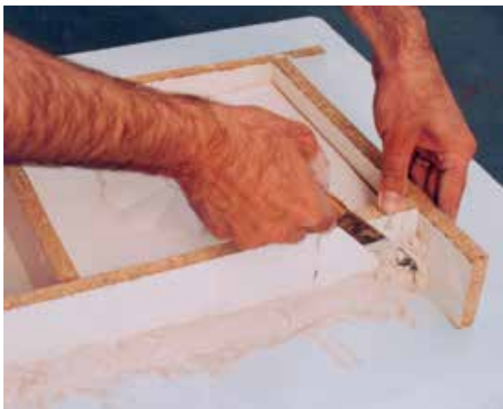
تصویر ۲- الف - ساختن دیواره در اطراف نمونه
