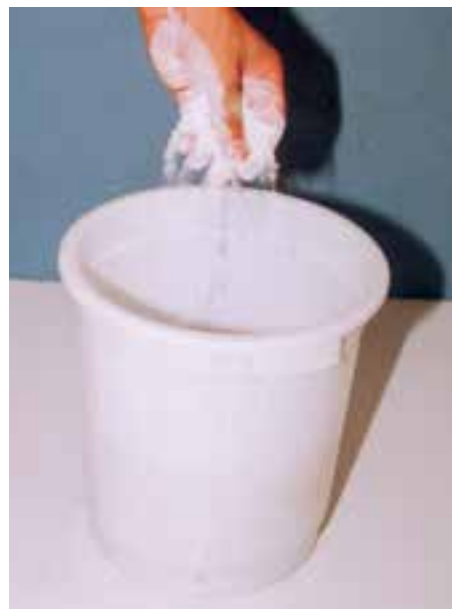
تصویر ۱- الف - ریختن پودر گچ در آب
