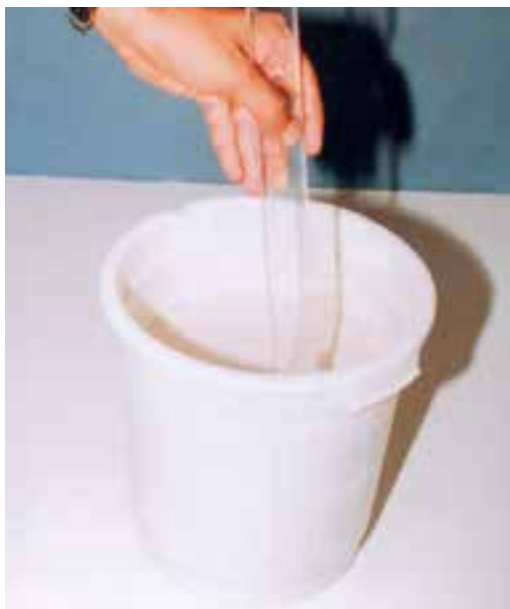
تصویر ۱- ب - مخلوط کردن دوغاب گچی با همزن دستی
