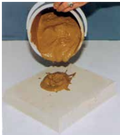
تصویر ۲- الف - ریختن گل شل روی یک صفحه گچی
