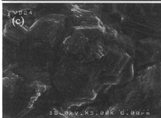
شکل ۱: تصاویر FE-SEM مربوط به پوشش روی خالص در دانسیته جریان های (a) ۰/۰۸، (b) ۰/۱ و (c) ۰/۱۲ A/cm 2 .
