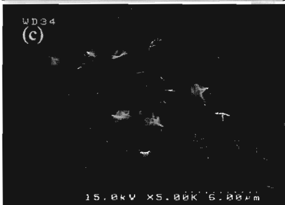
شکل ۲: تصاویر FE-SEM مربوط به پوشش نانوکامپوزیتی Zn-SiC (5 g/L) در دانسیته جریان های (a) ۰/۰۸، (b) ۰/۱ و (c) ۰/۱۲ A/cm 2 .
