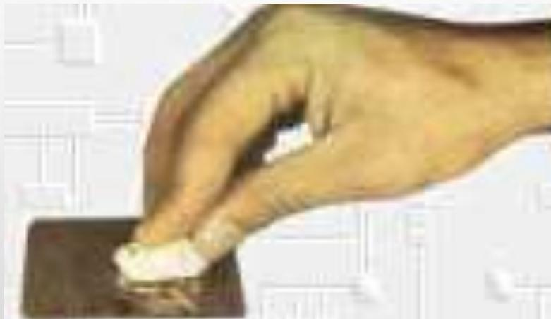
اگر فیبر را بلافارسله مورد استفاده قرار میدهید آماده نصب قطعات میباشد در غیر اینصورت چون ممکن است بر اثر مجاورت با هوا یک لایه اکسید روی آن را بپوشاند و در لحیم کاری دچار مشکلات شوید با کمی پنبه و فولکس در صورت نداشتن فولکس روغن لحیم روی آن لایه ای نازک بکشید.
