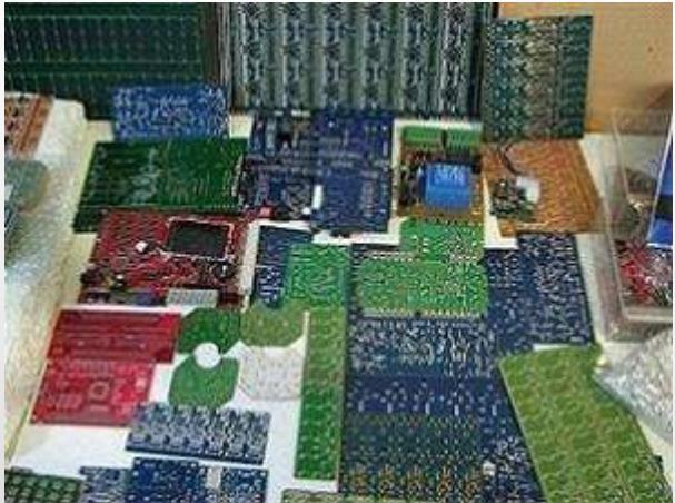
روی فیبر خام معمولاً لایه ای از مس با ضخامت هایی در حدود ۲۵ و ۵۰، ۷۵ میکرومتر پوشیده می شود که پس از طراحی مدار، این لایه ها به عنوان سیم رابط مورد استفاده قرار می گیرند.
