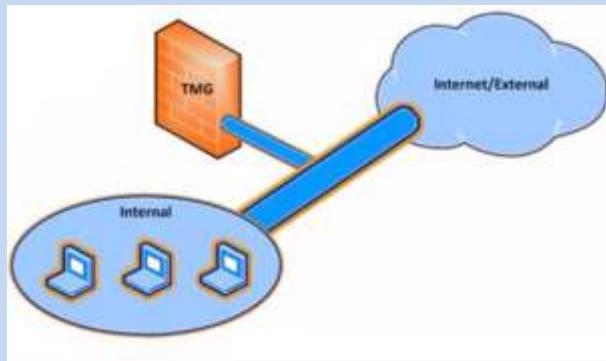
با انواع توپولوژیهای TMG در کتاب پیکربندی عملی آشنا شدید و سناریو Edge Firewall پیاده سازی شد. یکی دیگر از سناریوهای قابل پیاده سازی، سناریو single network adapter می باشد که می توان TMG را بر روی کامپیوتری با یک کارت شبکه نصب کرد، معمولاً از این پیکربندی زمانی استفاده می کنید که TMG به یکی از شبکه های زیر متصل می باشد:
