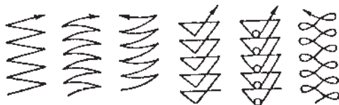
شکل ۳-۳۲- حالت‌های مختلف حرکت نوسانی نوک الکتروود
