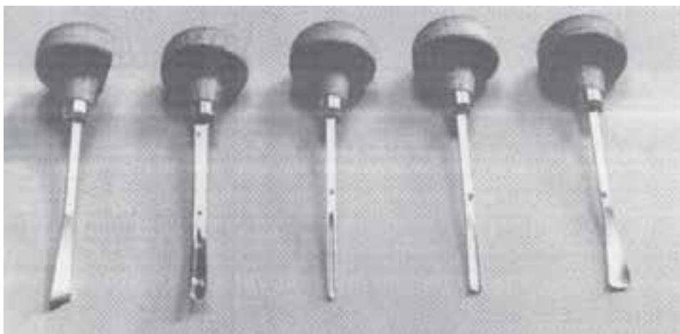
تصویر ۳۲- انواع مِغار که در حکاکی بر روی چوب کاربرد دارند.
