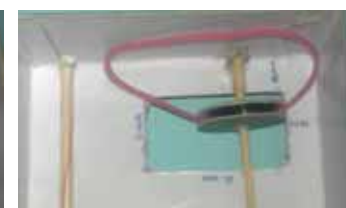
ت - عبور پولی و تسمه از محور
