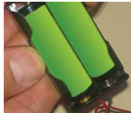
۳- قرار دادن باتری قلمی دوم در جای باتری به طور صحیح
