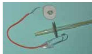
ت - بریدن دو عدد پولک برای پرچ کردن گیره‌ها و انتخاب نی پلاستیکی
