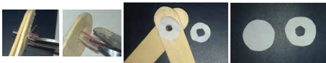
الف - ۴ عدد واشر مقوایی به قطر ۱۵ میلی‌متر ببرید و وسط دو عدد آن را به اندازه قطر نی سوراخ کنید. ب - یکی از واشرهای سوراخ شده را در یک طرف گونیا از نی عبور دهید. ب - محیط نی را به چهار قسمت کنید و هر قسمت آن را با قیچی شیار بزنید.
