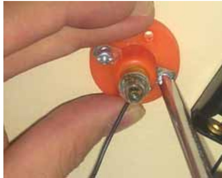
۱- بستن لامپ ۳ ولتی روی سرپیچ و بستن دو سرسیم جای باتری به دو سر اتصال سرپیچ
