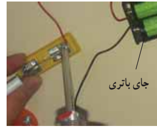
۲- برداشتن روکش از دو سر سیم و اتصال دادن یک سر آن به محل اتصال سربیش و اتصال سر دیگر کلید اهرمی
