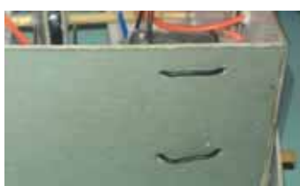
ث- عبور سیم از سوراخ ها به صورت خیاطی
