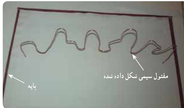
شکل ۳-۵ - نصب مفتول شکل داده شده به طور موقت روی پایه
