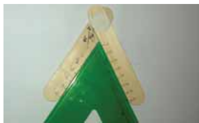
الف) قرار دادن گونیای واقعی بین دو بازوی گونیای ساخته شده و خط کشی آن
