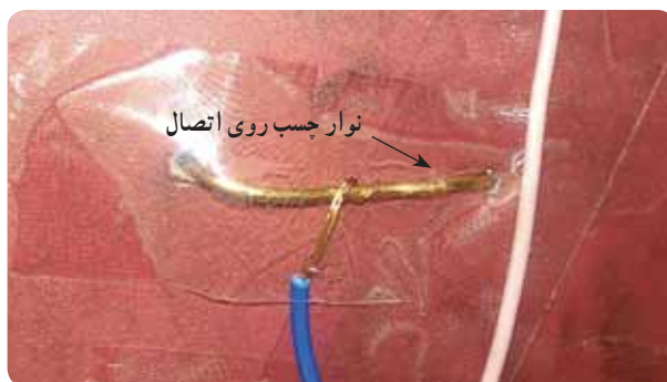
ب) اتصال سیم‌های باتری به LED و مفتول شکل داده شده
