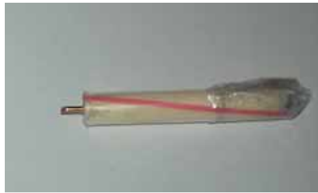
پ) بستن ته مجموعه نی و کابل آنتن به صورت تکیه‌گاه
