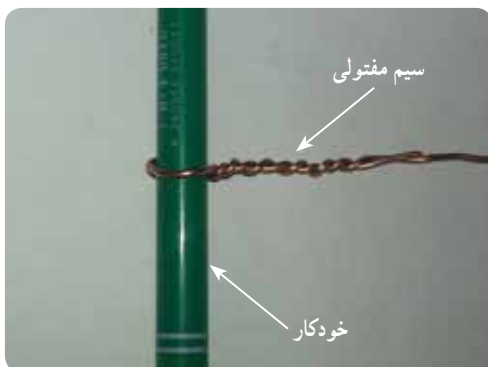
شکل ۳-۴- شکل‌دهی سرسیم مفتولی به صورت دایره
