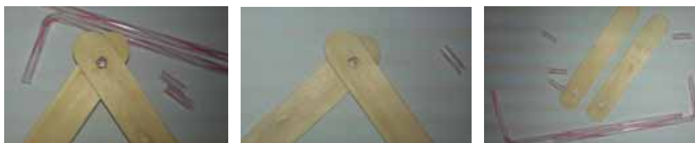
الف - سوراخ کردن یک طرف چوب‌های بستنی ب - انطباق سوراخ‌ها روی هم ب - اتصال دو چوب بستنی به یکدیگر با نی
