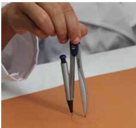
- ترسیم دایره روی مقوای فشرده با استفاده از پرگار با شعاع ۱۵ میلی متر
