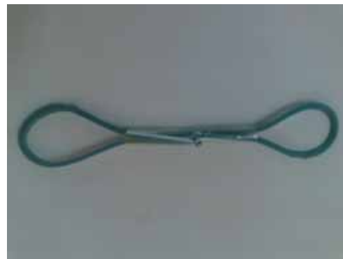
- پیچیدن مفتول برای ثابت کردن کش در لوله
