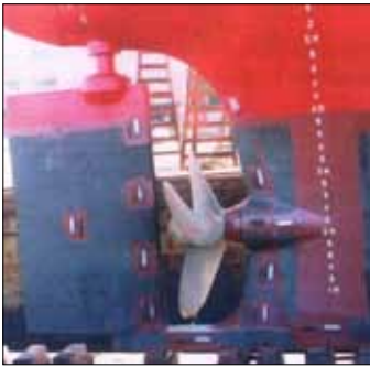
میله‌های منیزیمی در این قسمت از کشتی به کار گرفته می‌شوند.
