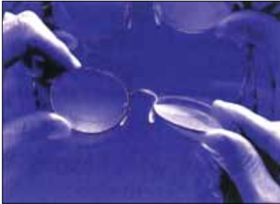
این نوع نیتینول در دمای اتاق به سرعت به شکل اولیه‌ی خود بر می‌گردد. در حال حاضر چنین عینک‌هایی کران قیمت هستند.
