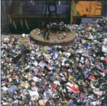
پداسازی قوطی‌های فولادی از سایر زباله‌ها با آهن‌ریا
