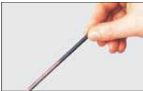
این الکتروود کربنی با لایه‌ای از فلز مس پوشیده شده است.
