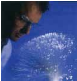
این فیبرهای شیشه‌ای می‌توانند اطلاعات را با استفاده از نور منتقل کنند. از هر فیبر به طور هم زمان ۱۰۰۰۰ مکالمه تلفنی می‌تواند صورت گیرد.
