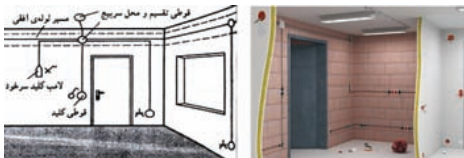
شکل ۶۱-۳ سیم‌کشی با جعبه تقسیم
