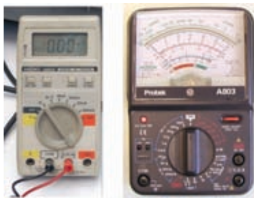
شکل ۳۷- ۱ مولتی متر آنالوگ و دیجیتال
