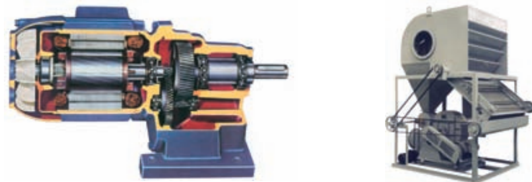
الف) کاربرد تسمه و چرخ تسمه در ماشین بوجاری ب) تغییر دور موتور با جعبه دنده شکل ۴-۲۹ کاربرد موتور ماشین‌های کشاورزی با تغییر دور
