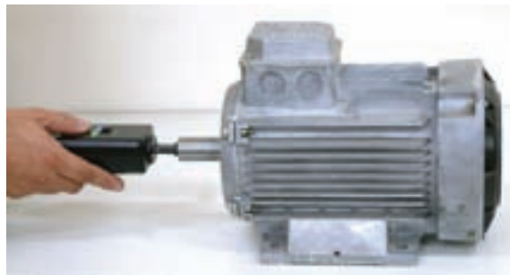
شکل ۲۷-۴ نحوه‌ی اندازه‌گیری سرعت دورانی موتور
