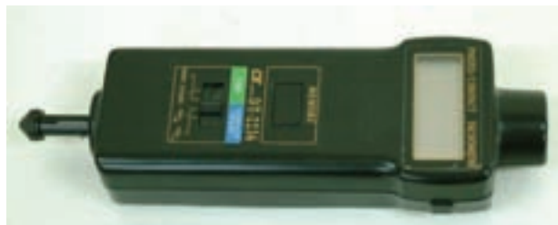
شکل ۲۶-۴ دورسنج دیجیتالی با حس‌کننده‌ی نوری و مکانیکی
