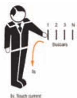
ب) تماس با بدنه فلزی دستگاه که اتصال بدنه پیدا کرده شکل ۱۱- ۲
