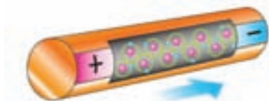
الف- ضربه‌های انرژی وارد شده به الکترون‌ها در یک سیم شکل ۱۲-۱
