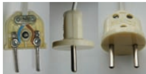
الف) دو شاخه معمولی بدون اتصال زمین
