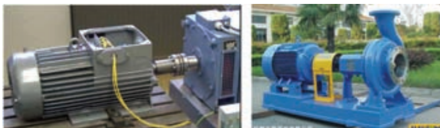
شکل ۴-۲۸ سیستم انتقال قدرت مستقیم
