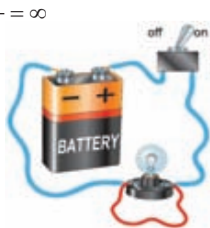
دو سر لامپ اتصال کوتاه شده شکل ۵۱-۱
