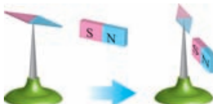
شکل ۴-۲۲ ورق آهنی حرکت آهنربا را دنبال می‌کند.
