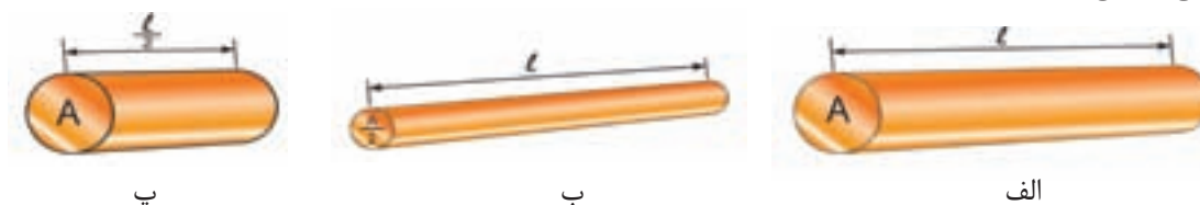
شکل ۱۹-۱ سیم‌ها در طول‌ها و سطح مقطع‌های متفاوت
