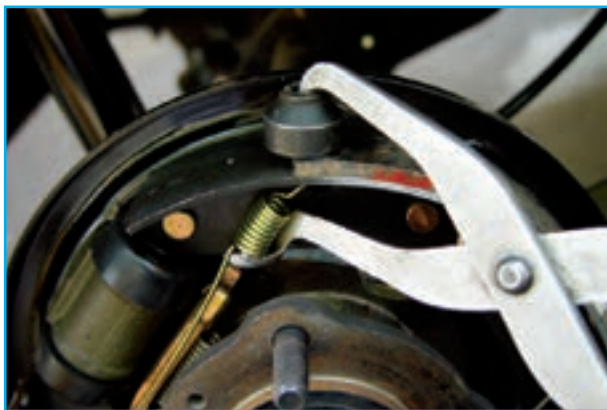
شکل ۹۱-۱- خارج کردن فنر بالایی
