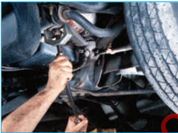
شکل ۲-۴۷- نحوه استفاده از نوعی سیبک کش
