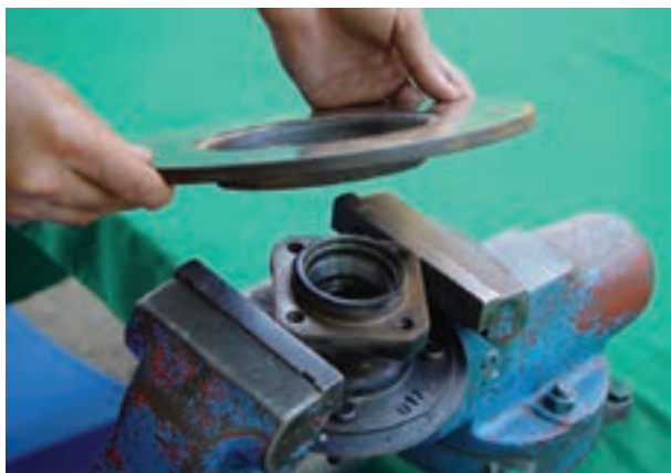
شکل ۳-۹۸- جدا کردن دیسک ترمز از تویی چرخ
