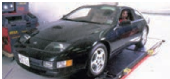
شکل ۳-۲۱۹ - دستگاه اندازه‌گیری زوایای رایانه‌ای (کامپیوتری)
