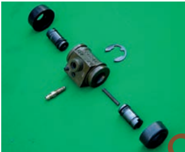
شکل ۱-۹۵ - اجزای پمپ ترمز چرخ
