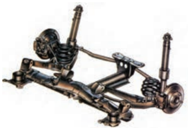
شکل ۳-۴۸- سیستم تعلیق مستقل عقب با چرخ‌های متحرک
