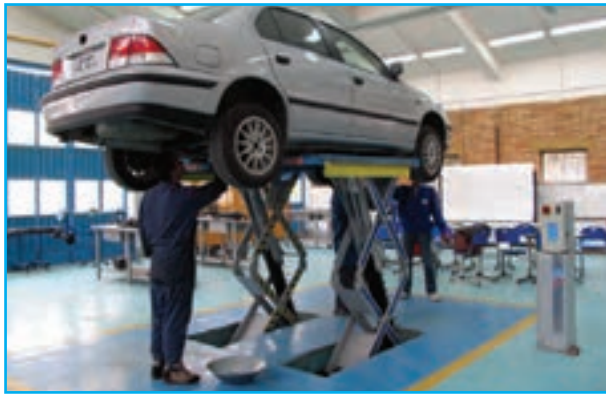
شکل ۲-۴۶- استقرار خودروی روی بالابر
