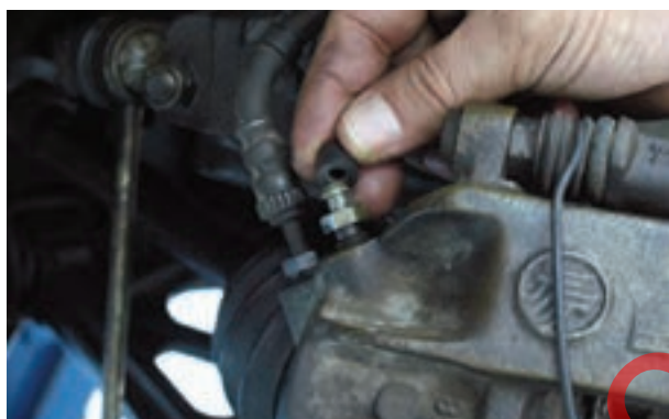
شکل ۱-۷۰- پاک کردن اطراف پیچ هواگیری
