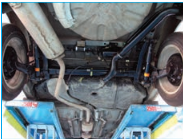
الف - باز کردن لوله‌های میانی و عقبی اگزوز
