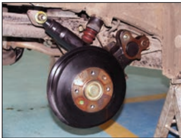
شکل ۳-۵۱- ژامبون و کمک فنر
