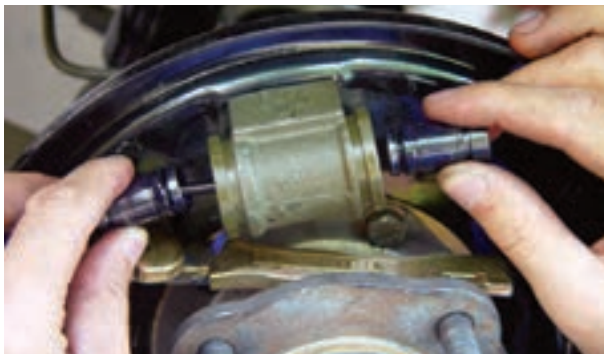
شکل ۱-۹۴ - خارج کردن پیستون‌ها
