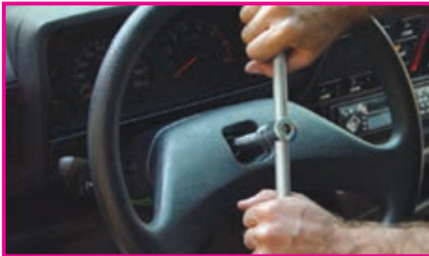
شکل ۲-۳۳- پیاده کردن فلکه فرمان
