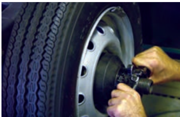
شکل ۲۳۴-۳- نصب چرخ روی دستگاه
