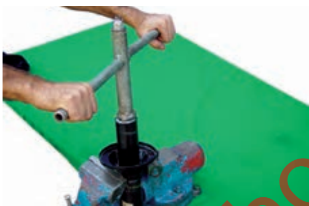
شکل ۳-۹۱- باز کردن مهره نگه‌دارنده کمک فنر
