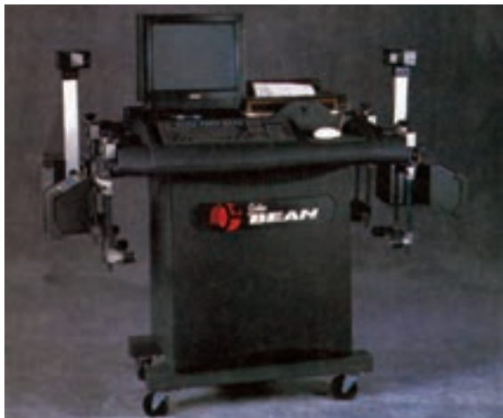
شکل ۳-۲۱۸ - دستگاه اندازه‌گیری زوایای نوری
