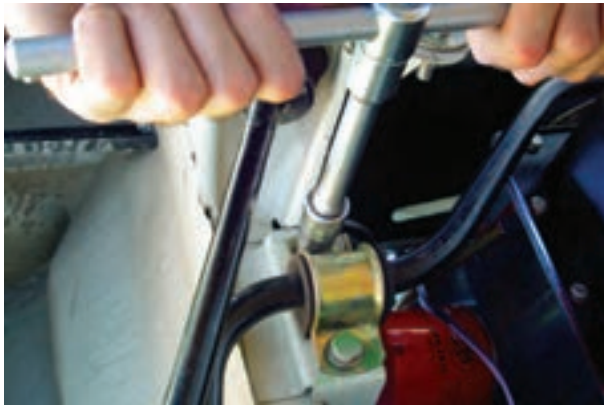
شکل ۳-۸۶- باز کردن میله ضد غلتش (موج گیر)
