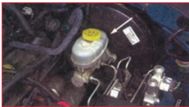
شکل ۱-۷۸- مخزن مایع ترمز و پمپ اصلی
