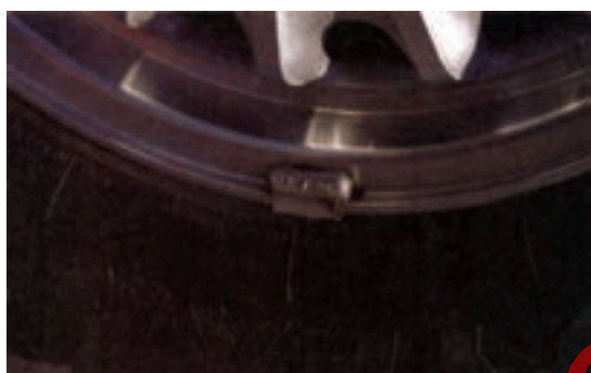
شکل ۳-۲۳۱- نصب وزنه روی رینگ
