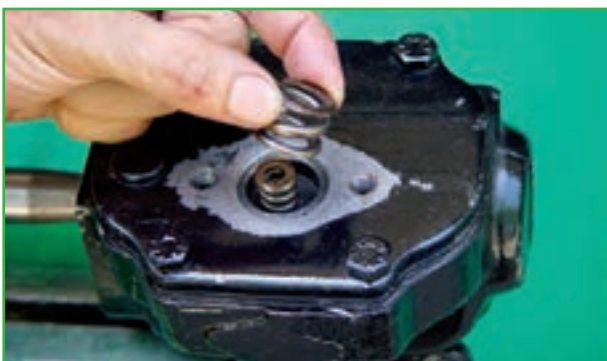
شکل ۲-۶۱- خارج کردن فنرها
