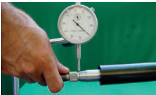
شکل ۶۹-۲- اندازه‌گیری لقی جانبی میل فرمان
