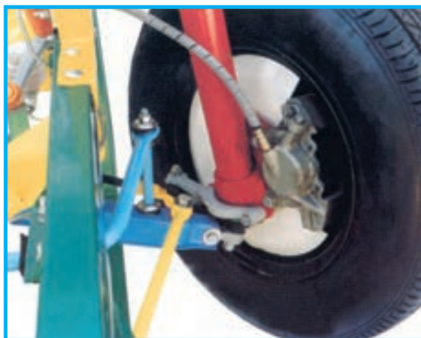
شکل ۱-۳۲- لوله مایع ترمز انعطاف پذیر
