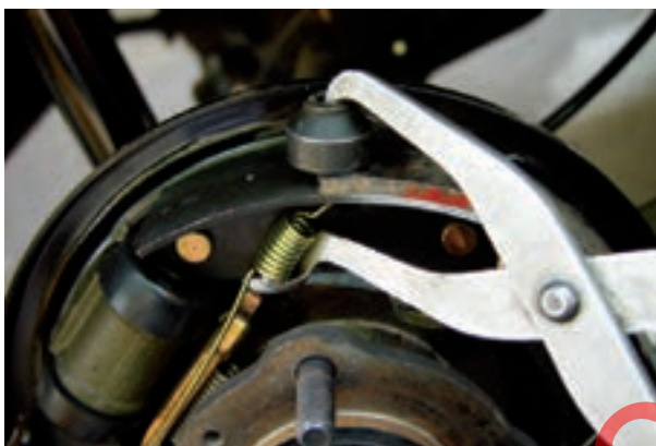
شکل ۱-۱۰۷- جازدن فنر بالایی کفشک
