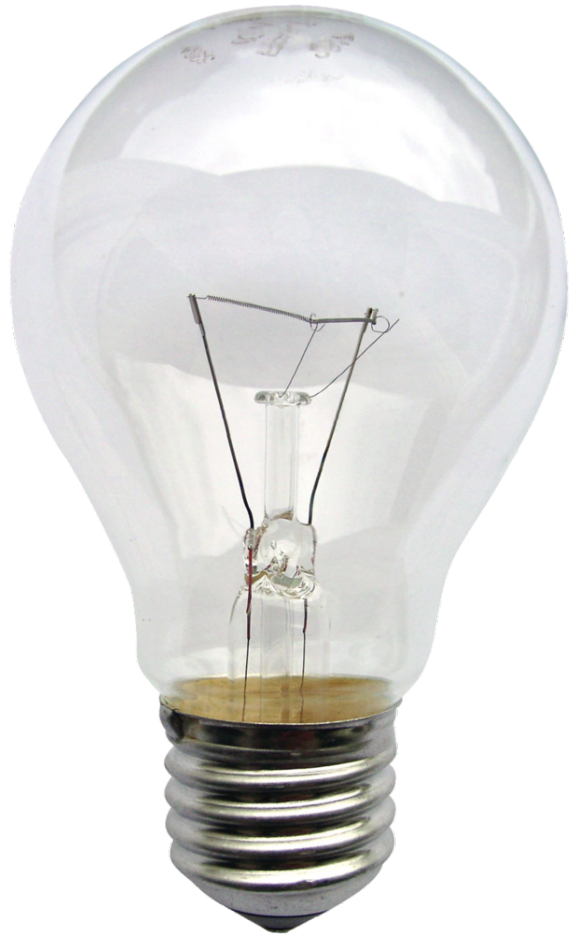
لامپ رشته‌ای، یکی از کاربردهای اولیه الکتریسیته که با گرمایی ژولی کار می‌کند: عبور جریان از مقاومت گرما تولید می‌کند.
