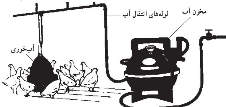
شکل ۶۱-۳- تجهیزات توزیع آب مکانیزه
