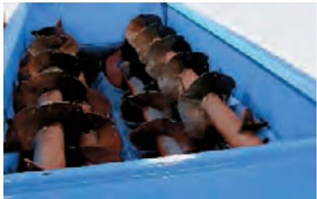
شکل ۵-۴—مارپیچ‌های مخلوط‌کن در مخزن مواد
