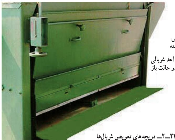
شکل ۲-۲۳ - دریچه‌های تعویض غربال‌ها
