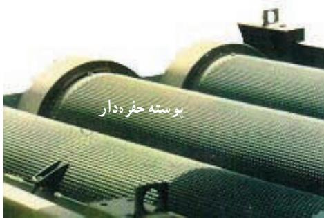
شده است از پوستهٔ حفره‌دار، ناآدانی، مارپیچ اصلی، هم‌زن، مارپیچ خروجی مواد ناخالص و تنظیم‌کننده (شکل‌های ۲-۸، ۲-۹ و ۲-۱۰).
