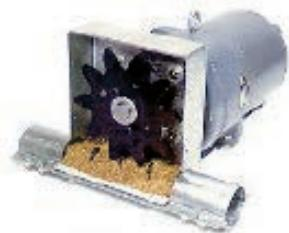
شکل ۳-۵۶- الکتروموتور و چرخدندهٔ محرک دان خوری مارپیچی
