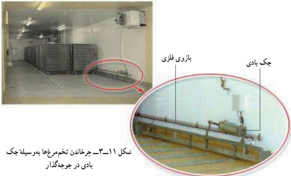
شکل ۱۱-۳- چرخاندن تخم مرغ‌ها به وسیله جک
