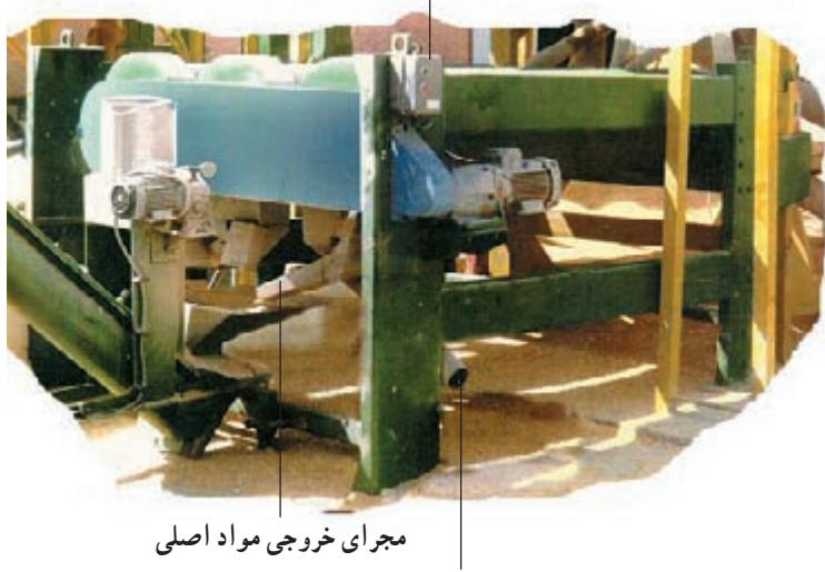
شکل ۲-۱۲- دستگاه بوجاری استوانه حفره‌دار در حال کار
