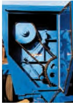
شکل ۷-۴- چرخ زنجیر و زنجیر انتقال نیرو
