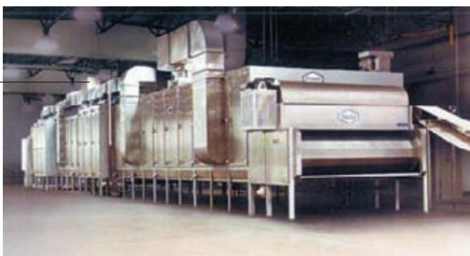
شکل ۱۴-۵ – تونل خشک کن
