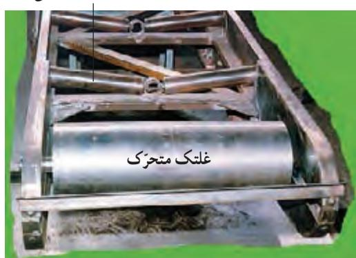
شکل ۱-۲- غلتک متحرک
