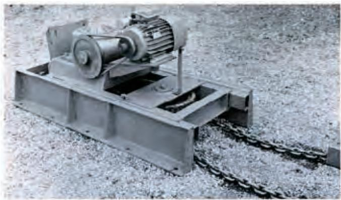
شکل ۴-۲۶ - الکتروموتور و زنجیر محرک تیغه
