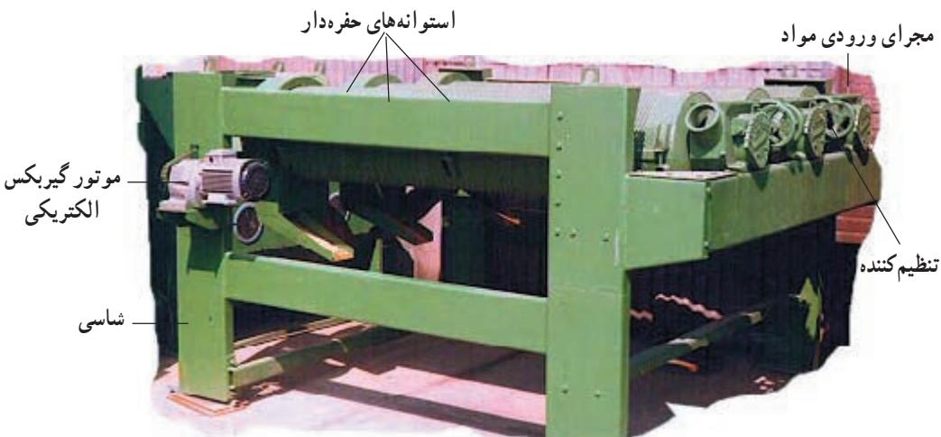
شکل ۲-۸- دستگاه بوخاری استوانه حفره‌دار
