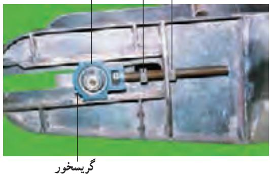
شکل ۱-۱۱- تنظیم کننده کشیدگی تسمه نقاله
