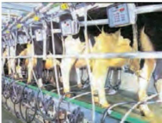
مخزن مدرج شیر می‌باشد و دارای یک کنترل کننده رایانه‌ای هستند (شکل ۴-۵۴).
