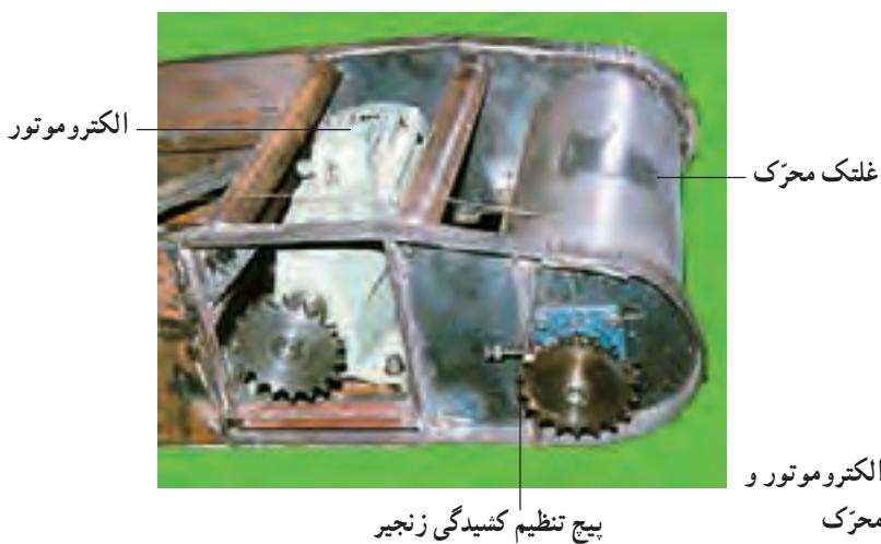
شکل ۱-۱۲- الکتروموتور و
