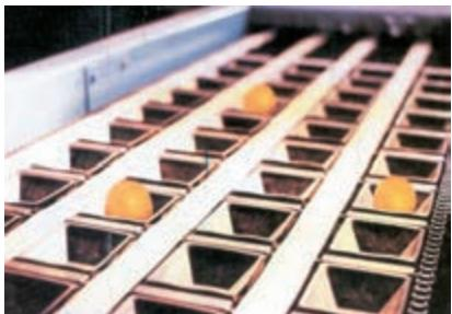
این دستگاه، معمولاً شامل چهار ردیف پیاله‌های حمل است که به وسیله زنجیرهایی که در دو طرف قرار دارند و از الکتروموتور نیرو می‌گیرند، حرکت می‌کند (شکل ۵-۸).
