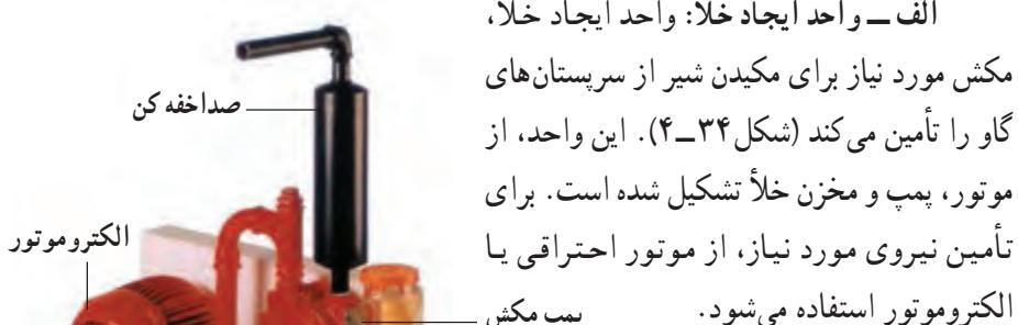
**الف - واحد ایجاد خلا:** واحد ایجاد خلا، مکش مورد نیاز برای مکیدن شیر از سرپستان‌های گاو را تأمین می‌کند (شکل ۱-۳۴). این واحد، از موتور، پمپ و مخزن خلا تشکیل شده است. برای تأمین نیروی مورد نیاز، از موتور احتراقی یا الکتروموتور استفاده می‌شود.
