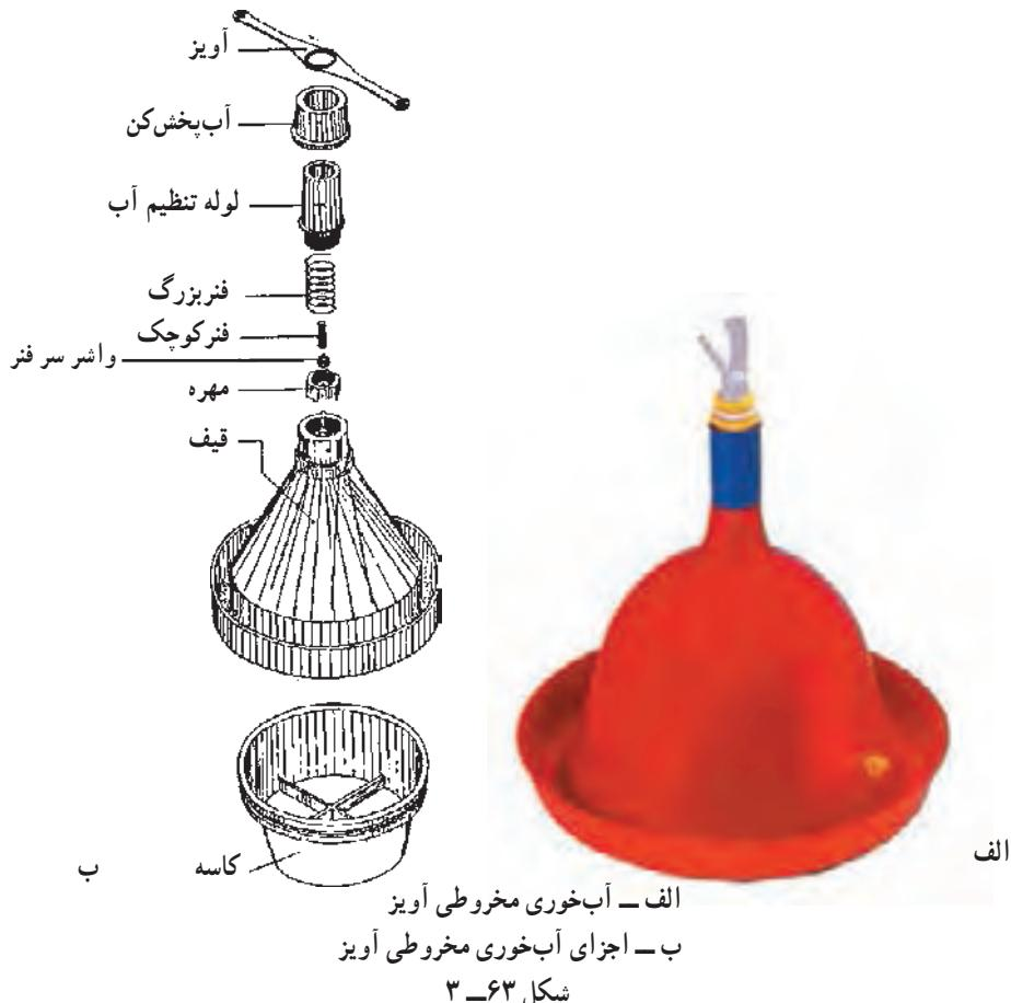
آویزان است و با تغییر ارتفاع آویز، ارتفاع آب خوری تنظیم می‌شود. بالای آویز، لوله‌ای خرطومی با طول متغیر به انضمام شیلنگ‌ها، رابط‌ها و سیستم قطع و وصل آب وجود دارد که همگی به لوله انتقال آب متصل هستند.
