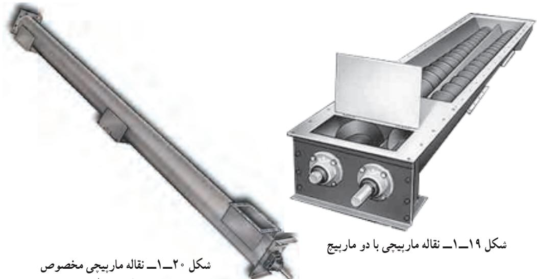
شکل ۱-۱۹—نقاله مارپیچی با دو مارپیچ
