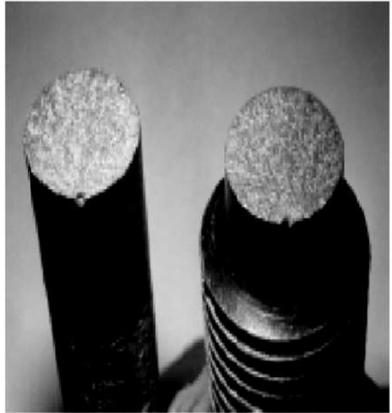
شکست ترد در فولاد (بیشتر در مواد با ساختار FCC و HCP در دماهای پایین)
