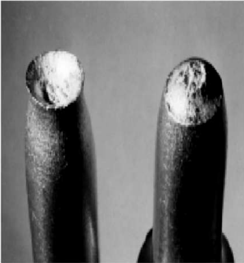
شکست مخروطی-ناودانی (شکست نرم در آلومینیم) بیشتر در مواد با ساختار BCC
