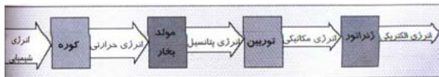
مراحل تبدیل انرژی شیمیایی به انرژی الکتریکی در یک نیروگاه بخار
