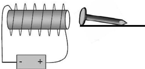
۵۴- مطابق شکل رو به رو، از یک سیم پیچ که دور یک میله آهنی پیچیده شده است، جریان الکتریکی ثابتی می‌گذرد. یک میخ آهنی که روی سطح بدون اصطکاک قرار دارد، جذب میله آهنی درون سیم پیچ می‌شود. کدام گزینه در مورد حرکت میخ درست است؟
