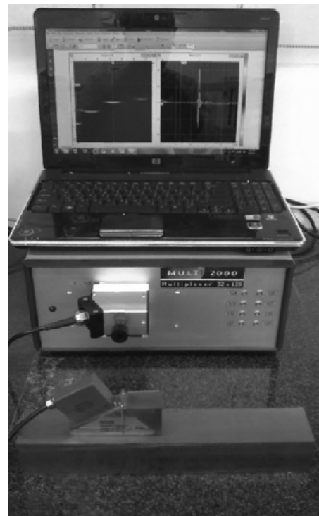
شکل ۸: تصاویر دستگاه آرایه فازی، رایانه، پراب و کفشک.
