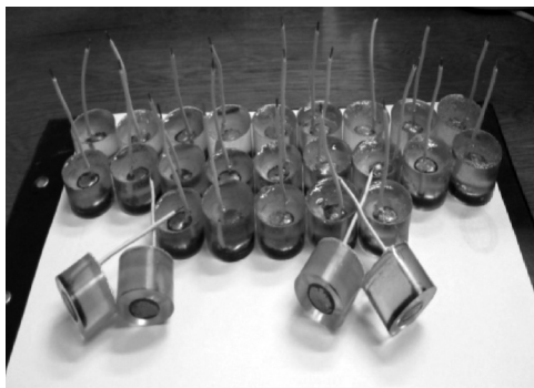
شکل ۱- کاتدهای مانع سرد شده مورد استفاده به عنوان زیرلایه پوشش.
