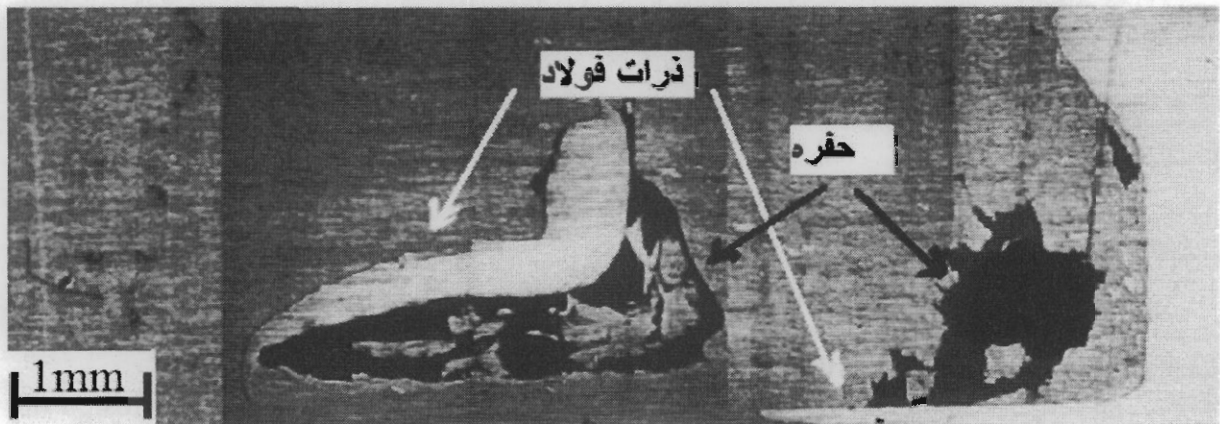
شکل ۹: حفره‌های ایجاد شده در مجاورت ذرات فولاد در ناحیه اغتشاش
