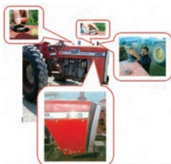
شکل ۵-۴۸- مراحل باز کردن کاپوت تراکتور
