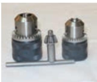
باز و بسته کردن فک‌های سه‌نظام به وسیله دست (سه‌نظام خودکار) یا به وسیله آچار سه‌نظام (سه‌نظام آچارخور) انجام می‌شود.
