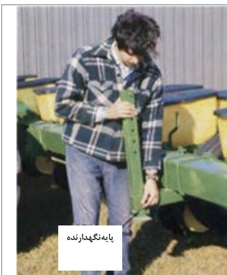
شکل ۳-۷۹- جدا کردن ماشین از تراکتور
