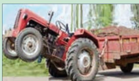
در هنگام اتصال پی‌نورد دو چرخ به تراکتور در صورت سبک بودن جلوی تراکتور چه اتفاقی می‌افتد؟
