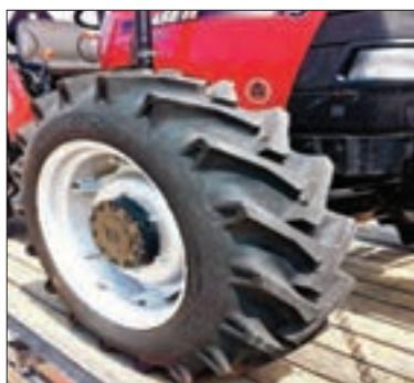
شکل ۲۱-۵- چرخ با فشار باد تنظیم شده
