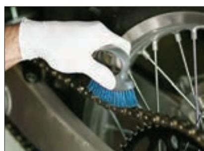
شکل ۲-۱۴- تمیز کردن زنجیر
