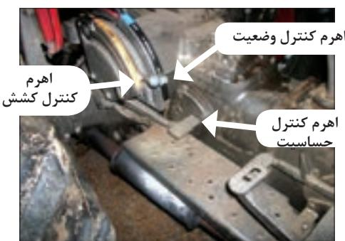
شکل ۳-۵۹- اهرم‌های کنترل هیدرولیک تراکتور فرگوسن ۲۸۵
