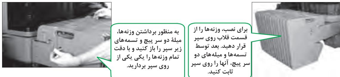
شکل ۵-۴۱- نصب وزنه کیفی
