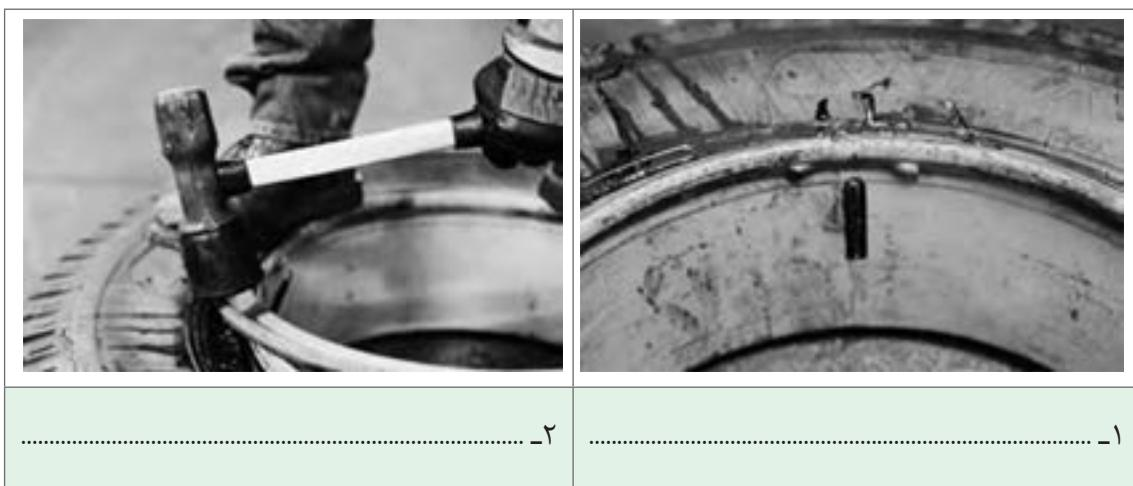
شکل ۵-۳۲- جازدن تایر روی رینگ دو تکه
