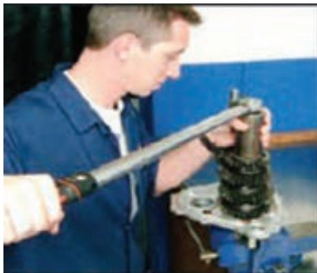
شکل ۱-۱۲- کار با تُرك متر قابل تنظیم
