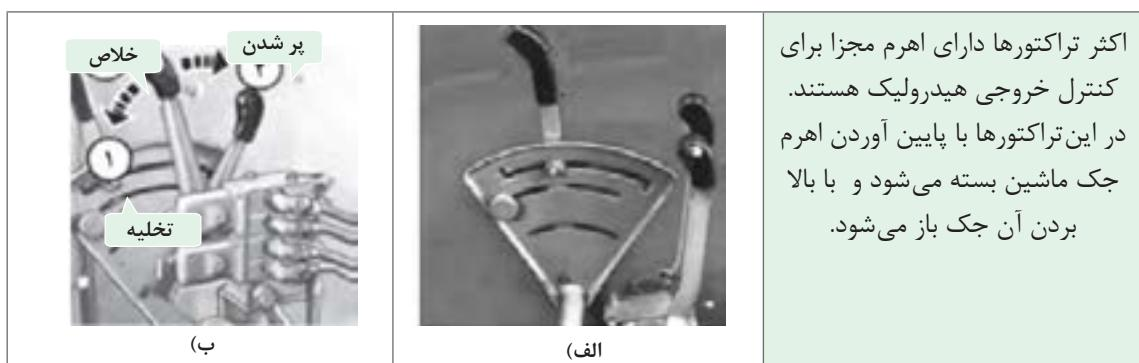
شکل ۴-۲۴- اهرم جک هیدرولیک تراکتور
