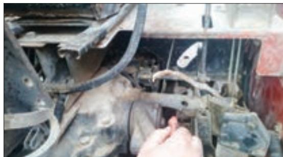
شکل ۲۹-۳- گیج روغن هیدرولیک تراکتور فرگوسن ۳۹۹
