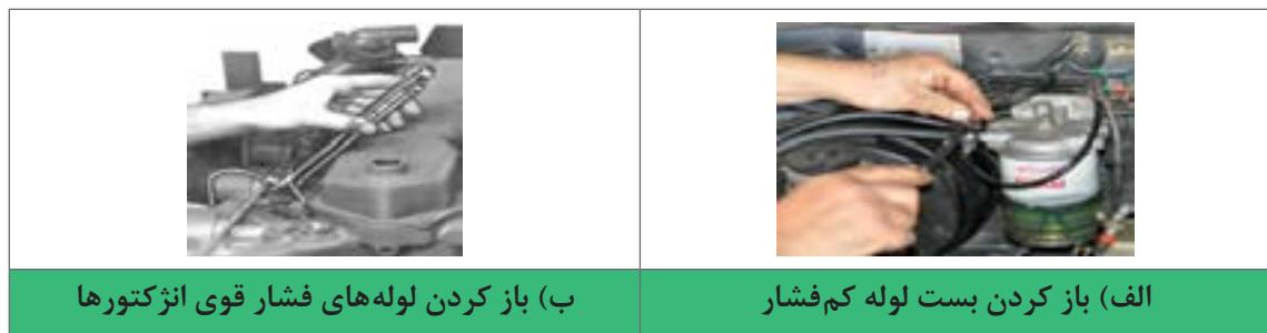
شکل ۳-۶۵- باز کردن لوله‌ای گازوئیل
