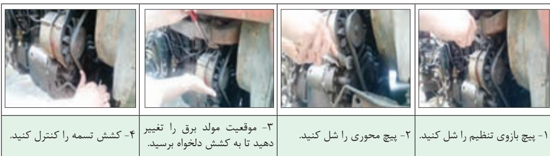
شکل ۲-۳۹- تنظیم کشش تسمه پروانه
