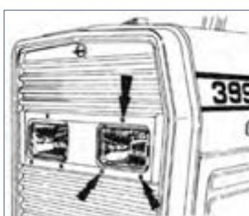
شکل ۳-۱۸- پیچ های تنظیم چراغ
