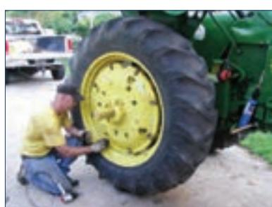
شکل ۱-۲۳- استفاده از دستکش برای باز کردن چرخ
