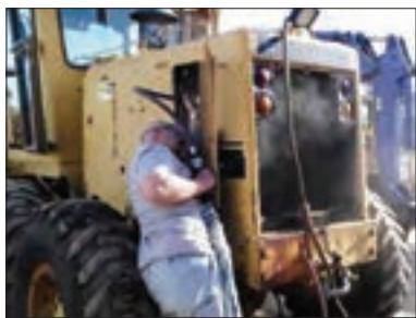
شکل ۴۱-۲- تمیز کردن رادیاتور
