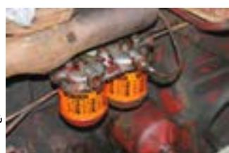
نشتی در لوله‌ها و شیلنگ‌های سوخت رسانی علاوه بر اینکه سبب اتلاف سوخت و آلودگی محیط‌زیست می‌گردد سبب نفوذ هوا به مدار سوخت رسانی می‌شود.
