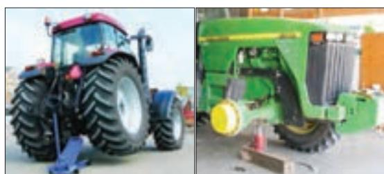
شکل ۱-۲۲- جک زدن زیر تراکتور
