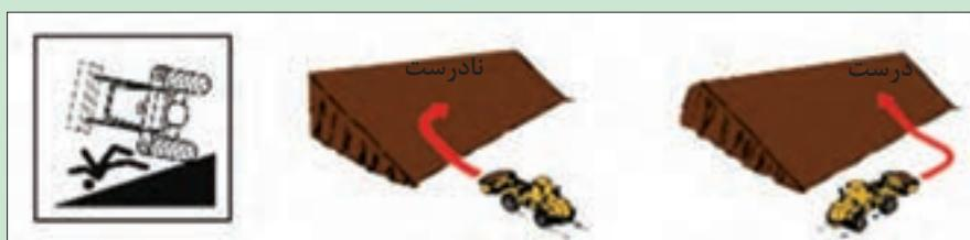
شکل ۴-۴۲- حرکت صحیح روی شیب در جایه‌جایی حمل بار
