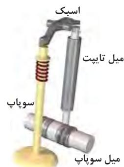
mekanizm ساده (mekanizm سوپاپ‌ها)
