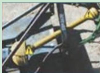
شکل ۳-۷۶- حداکثر زاویه گاردان ۲۵ درجه است.
