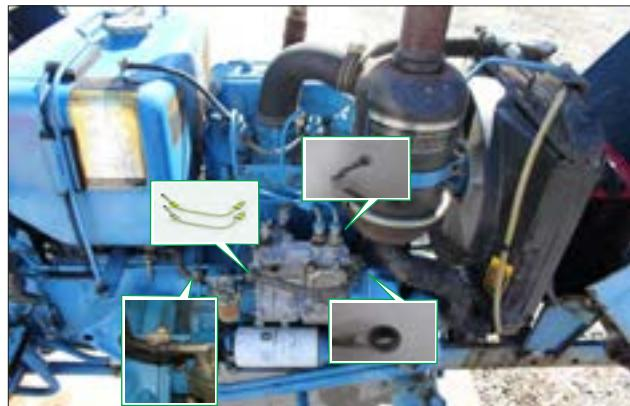
شکل ۳-۶۴- لوله‌ها و شیلنگ‌های سوخت‌رسانی موتور تراکتور
