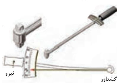
شکل ۱-۱۳- تُرك متر عقربه‌ای
