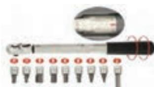
شکل ۱-۱۶- تنظیم ترک متر قابل تنظیم
