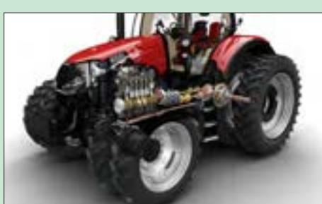
شکل ۳-۱۹- سیستم انتقال توان
