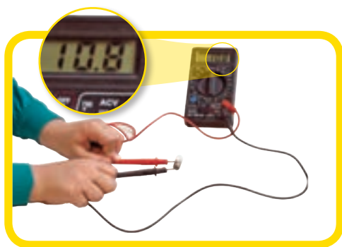
شکل ۸- اندازه‌گیری مقاومت لامپ خاموش با اهم متر
