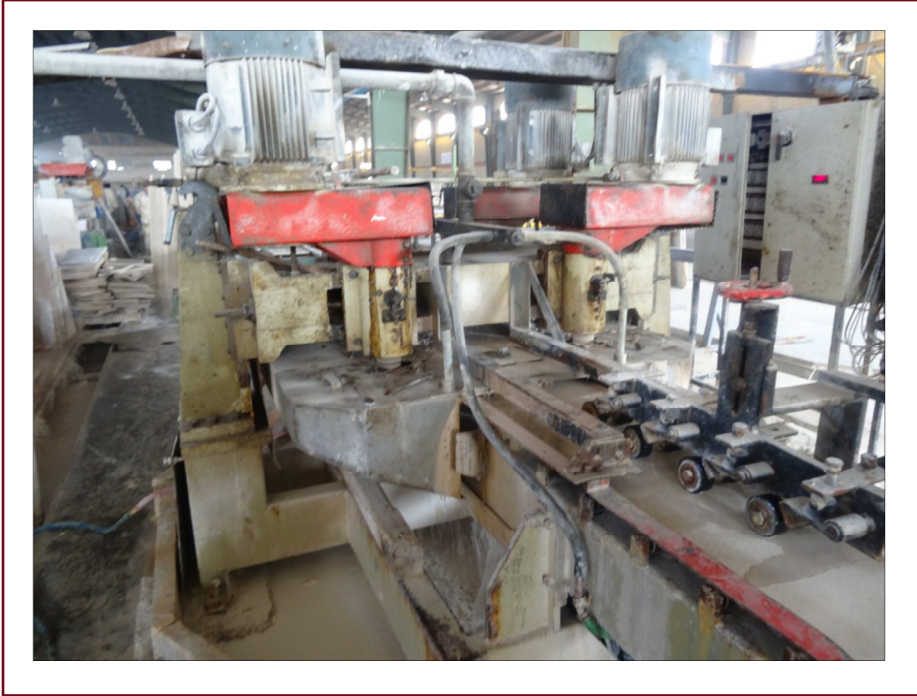
شکل ۲-۷: دستگاه ساب یا پرداخت
