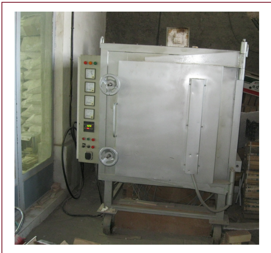
شکل ۵-۲: کوره صنعتی در کاشی سازی سنتی
