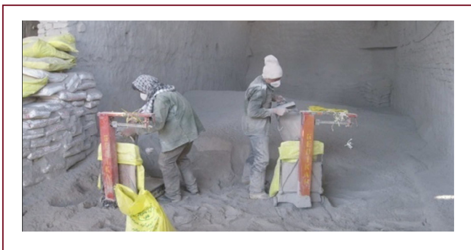
شکل ۳-۲: پر کردن و وزن کردن کیسه های سیمان
