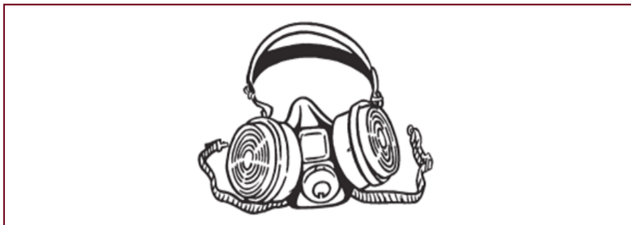
شکل ۴-۱۷: ماسک تنفسی در جوشکاری
