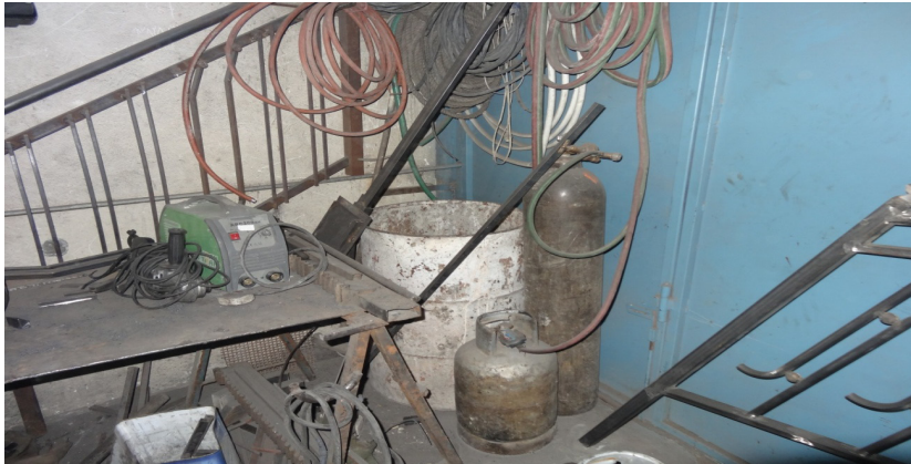
شکل ۴-۵: کیسول گاز و هوا در جوشکاری
