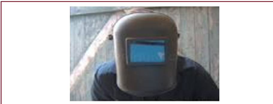
شکل ۴-۱۶: حفاظت صورت در جوشکاری
