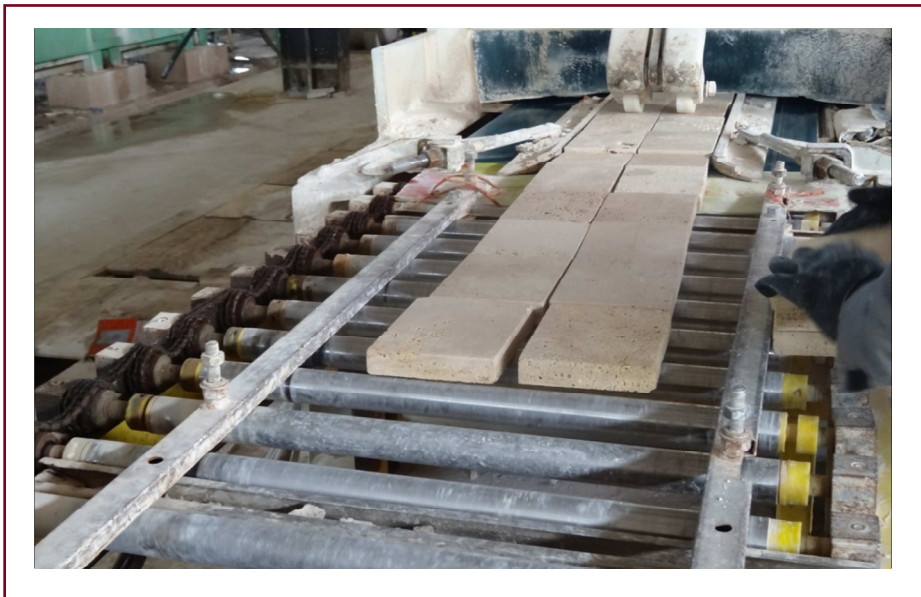
شکل ۲-۶: دستگاه ساب (نقاله)
