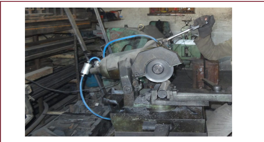
شکل ۴-۴: اره برای برش دادن قطعات
