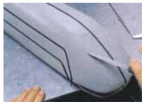
۷- با استفاده از زوار خطوط اصلی روی مدل اجرا می‌گردد.
