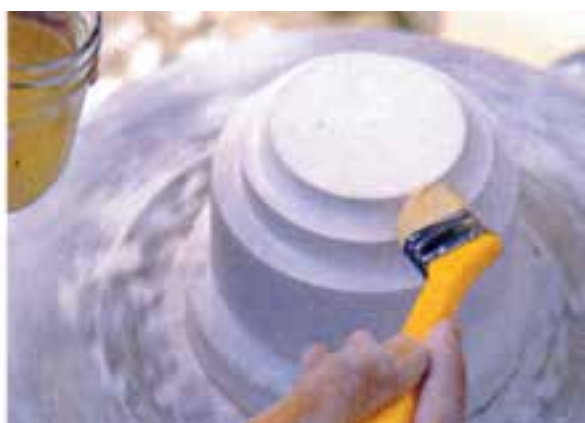
۱۲- مرحله زدن مایع جدا کننده برای گذاردن گچ روی پایه ساخته شده
