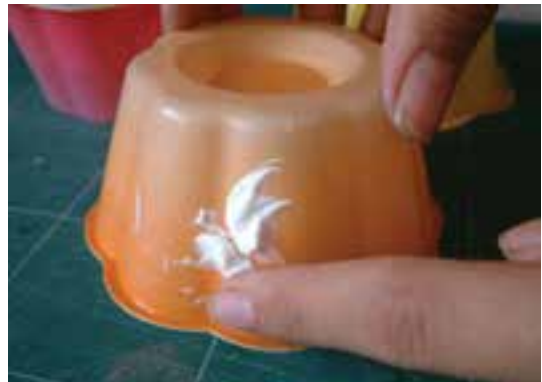
۱- زدن ماده جداکننده به مدل
