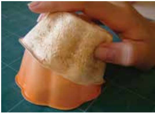
۴- خروج قطعه از روی مدل
