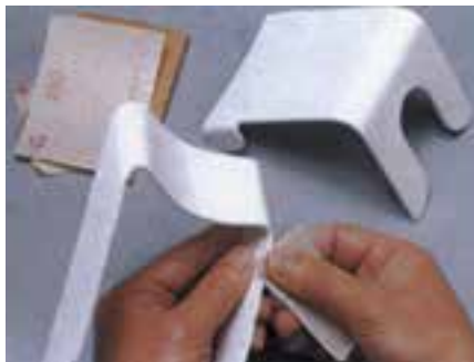
۶- در این مرحله لبه های مدل پرداخت می شود و کار، نهایی می گردد.
