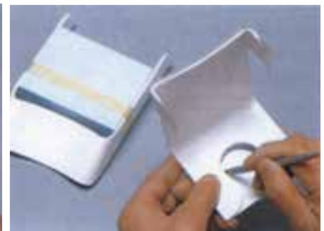
۵- پس از فرم دهی کل یک سطح، قسمتهای مورد نظر بریده می شود.
