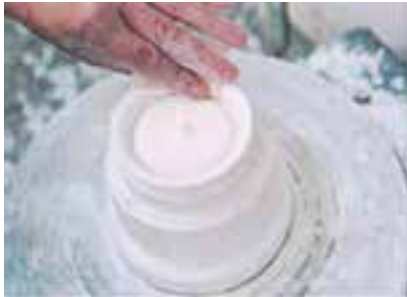
۱۶- سنباده زدن انحنا و نهایی کردن
