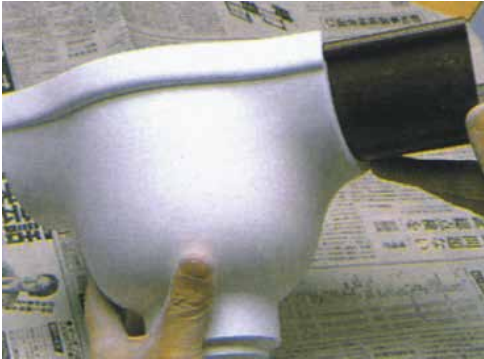
۲۲- لبة قطعه را بررسی کنید و مطمئن شوید بقیه اجزای مدل به خوبی با آن جفت می‌شوند.
