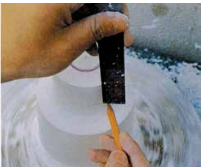
۶- اندازه‌ها در هر لحظه کنترل می‌شوند. مرحله دوم ساخت آغاز می‌شود.
