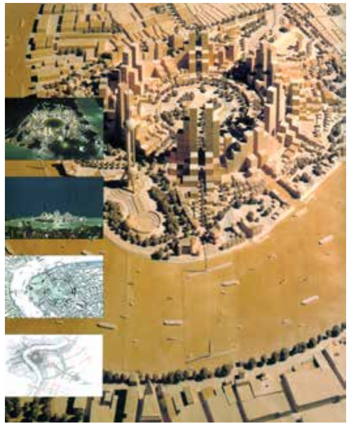
شکل ۳۹- تصویر ماکتهای اتود و گذرا را در حاشیه تصویر اصلی برای تفهیم می‌توان دید و همچنین اتود و «کلیت» بودن در ماکت فضای شهری از سادگی عناصر تشکیل‌دهنده آن مشهود است - ساخته شده از مقوای ماکت - استایروفوم - بلوفوم - یلوفوم و مواد دیگر برای عناصر ریز آن.
