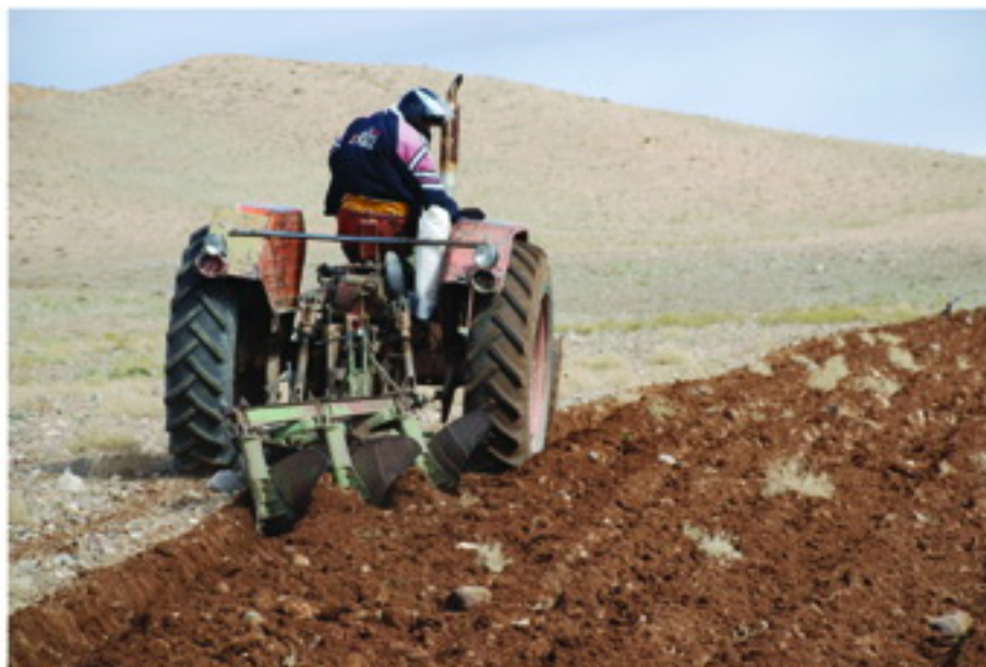
شکل ۴- شخم با گاو آهن برگردان دار خاک را بدون پوشش می کند
