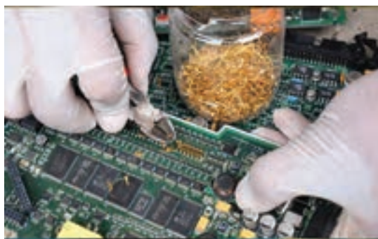
شکل ۶۱- به کارگیری فلزات گرانبها در بوردهای الکترونیکی
