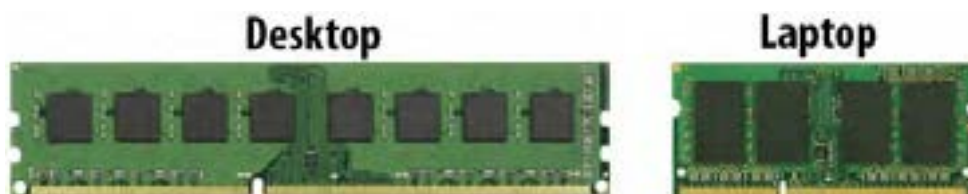
شکل ۲-۱۹: دو نوع حافظه RAM به کار رفته در ریز رایانه ها
