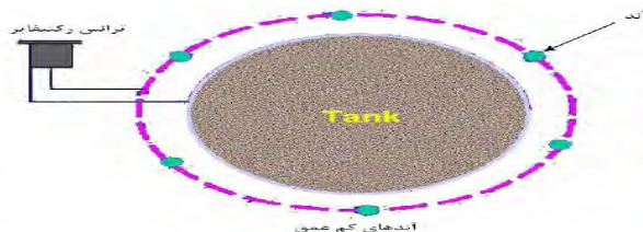
شکل 2. بکارگیری آندهای کم عمق در اطراف هر مخزن مشاهده می شود
