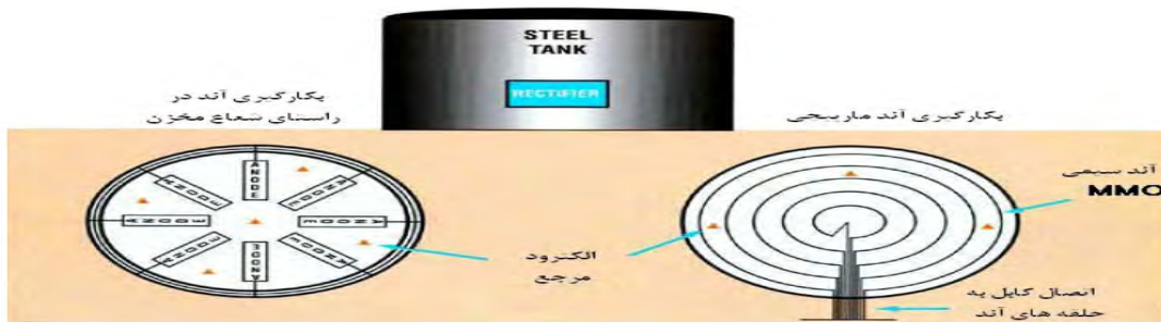
شکل 5. در این شکل بکارگیری آندهای سیمی MMO به شکل مارپیچ در زیر کف مخزن مشاهده می شود. کلیه حلقه ها به یکدیگر متصل می باشند ولی برای اطمینان بیشتر کابل آندها به یک حلقه، به کلیه حلقه ها متصل شده است. در شکل سمت چپ بکارگیری آندها در راستای شعاع مخزن مشاهده می شود. همچنین در این شکل الکترود مرجع دائمی در نقاط مختلف زیر کف مخزن بکار رفته است.
