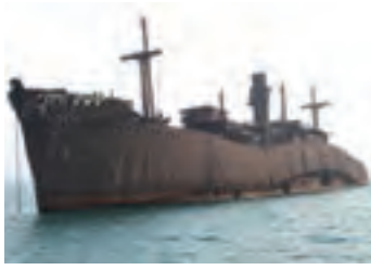
شکل ۳- زنگ زدن بدنه فولادی کشتی‌ها یک واکنش اکسایش - کاهش ناخواسته است.
