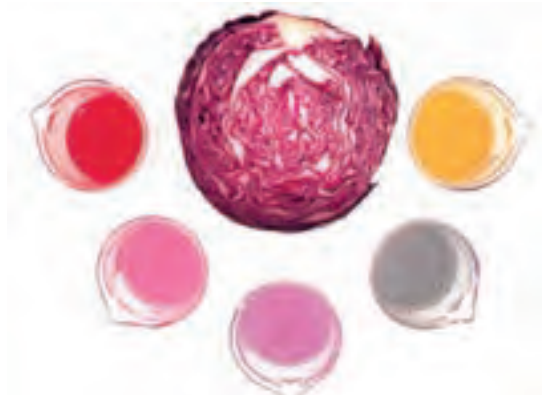
شکل ۹- آب کلم سرخ به عنوان یک شناساگر اسید-باز عمل می کند. محلول های نشان داده شده از چپ به راست pH های ۱، ۴، ۷، ۱۰ و ۱۳ دارند.
