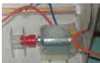
ت - چسباندن مجموعه موتور با چسب همه کاره روی بدنه
