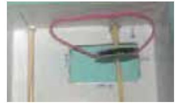
ث- عبور پولی و تسمه از محور
