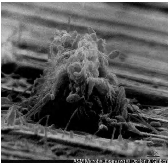
شکل (۱) - تصویری از یک نوع باکتری سیسیلی (بی ساقه) در خوردگی میکروبی
