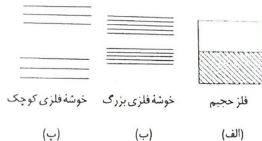
شکل ۸-۱- الف- ساختار انرژی یک ماده معمولی به شکل نوار انرژی، ب- ساختار انرژی نانوذرات بزرگ (بین ۸۰ تا ۱۰۰ نانومتر) و پ- ساختار انرژی نانوذرات کوچک
