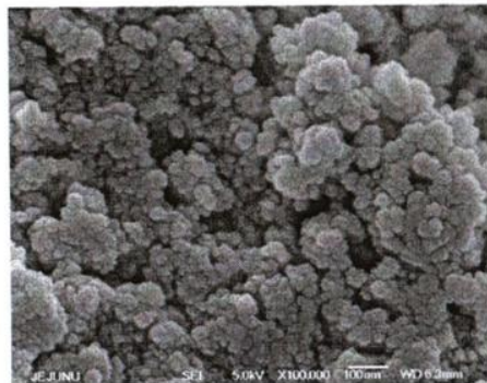
شکل ۲-۹- تصویر SEM نانوذرات HfO 2 تهیه شده با روش رسوب‌گذاری
