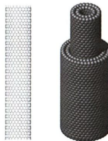
شکل ۴-۱۳- نانولوله‌های کربنی تک دیواره (سمت راست) و چند دیواره (b) (سمت چپ)
