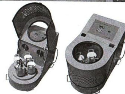
شکل ۲-۱۰- نمایی از دستگاه و محفظه قرارگیری پودر آسیاب گلوله‌ای
