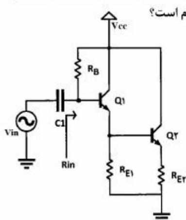
در مدار زیر، اگر  $\beta_1 = \beta_2 = \beta$  و  $r_{e1} = r_{e2} = \infty$  باشد، مقاومت ورودی کدام است؟
