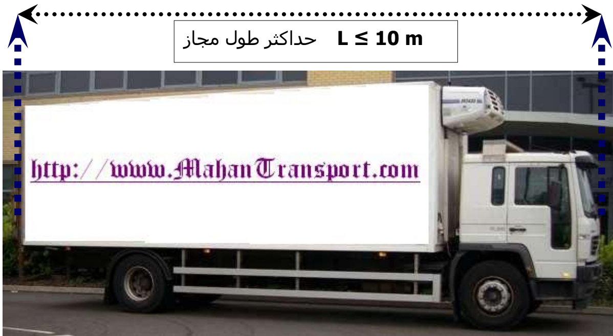
(شکل ۲-۶) نمایش حداکثر طول مجاز کامیون دو محور
