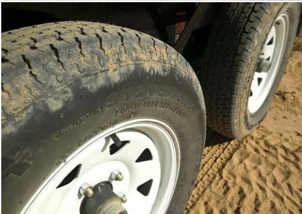
(شکل ۲-۲۱) فرسایش لاستیک‌ها به واسطه فشار بار بالا
