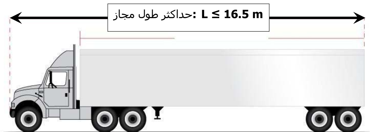
(شکل ۲-۸) تصویر حداکثر طول مجاز تریلی ۴ محور و بیشتر
