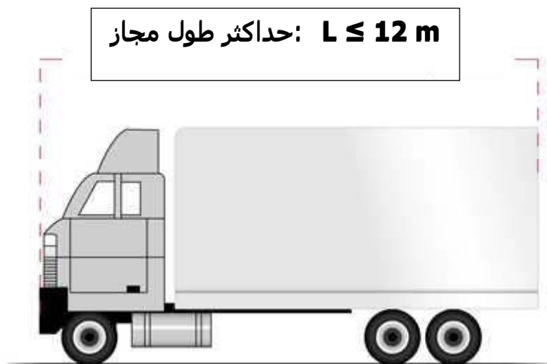
(شکل ۲-۷) تصویر حداکثر طول مجاز کامیون سه محور
