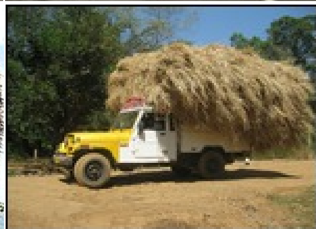
(شکل ۲-۱۴) تصاویری از عدم رعایت طول و عرض و ارتفاع مجاز بارگیری وسیله نقلیه
