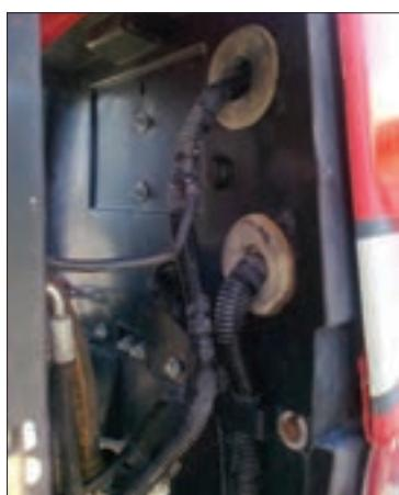
شکل ۳- ثابت کردن کلاف روی بدنه تراکتور
