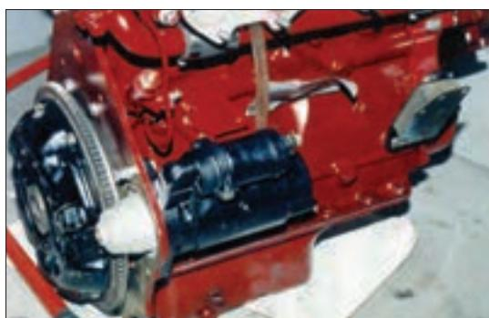
شکل ۳۳—اتصال موتور استارتر به دنده فلایویل
