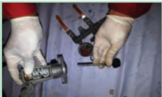
۴- دیافراگم معیوب را از روی سوپاپ فشار برداشته و تعویض کنید. سپس عکس مراحل باز کردن قطعات را مونتاژ کنید.
