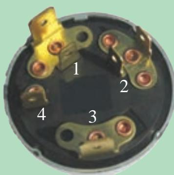
شکل ۱۱- سوئیچ تراکتور MF ۲۸۵
