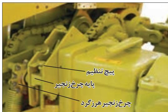
شکل ۷-زنجیر سفت کن با چرخ زنجیر واسطه
