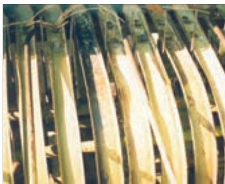
شکل ۶- ساییده شدن انگشتی‌ها به تسمه‌های راهنما
