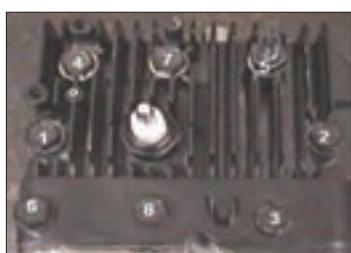
شکل ۳۴- ترتیب بستن پیچ های سرسیلندر
