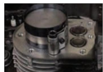
شکل ۳۲- جا زدن پیستون
