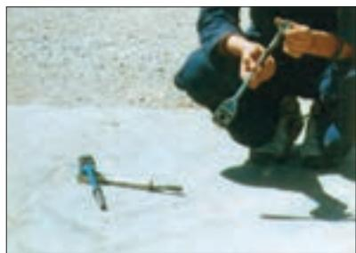
در انواعی از دروگرهای می‌توان عمل تطابق را به وسیله پیچ قابل تنظیم روی چلاق دست انجام داد (شکل ۵۸).
