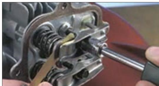
شکل ۳۵- فیلر کردن سوپاپ
