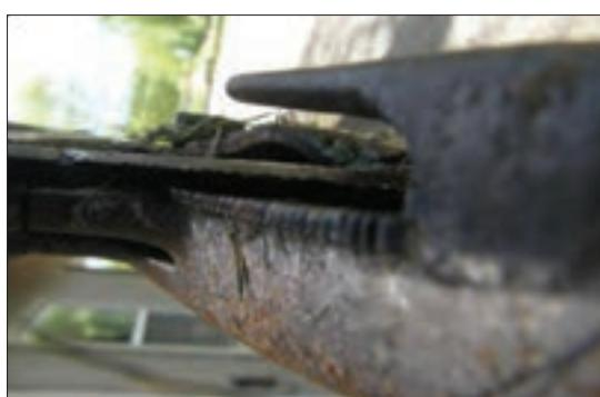
شکل ۵۴- فاصله بین لبه بُرندۀ تیغه و لبه بُرندۀ انگشتی
