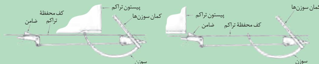
شکل ۶۷- عملکرد ترمز پیستون
