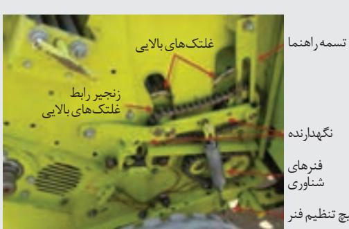
شکل ۴۰- قطعات مرتبط با غلتک‌های بالایی
