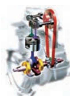
شکل ۳- میل سوپاپ بالای سیلندر
