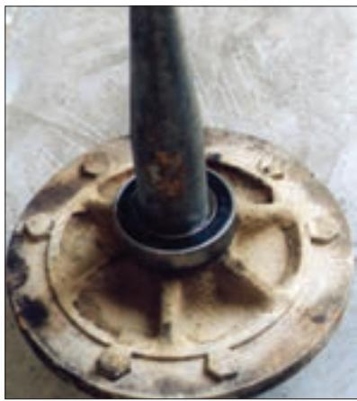
شکل ۴۹- محور استوانه و بلبرینگ
