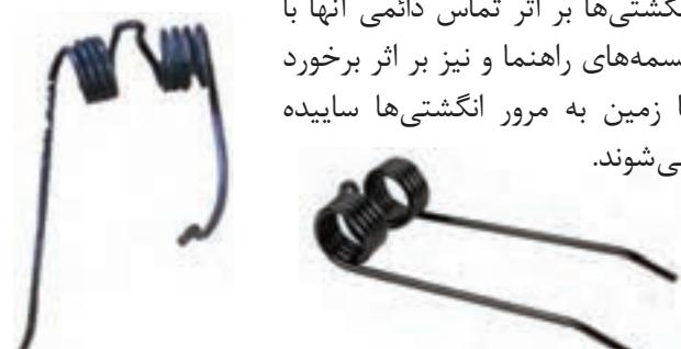
شکل ۴- تفاوت انگشتی سالم و انگشتی معیوب
