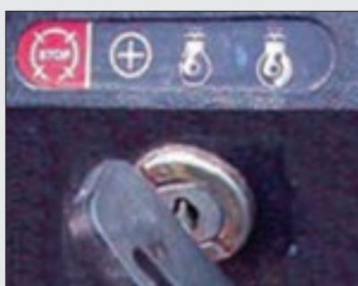
شکل ۹- مراحل سوئیچ تراکتور MF ۳۹۹
