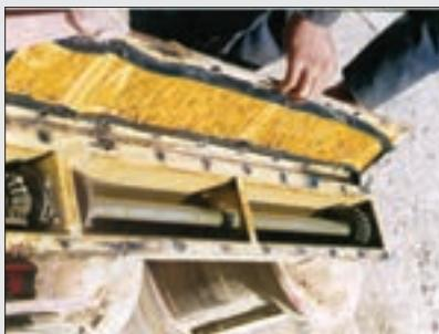
شکل ۲۱- برداشتن سرپوش جعبه‌دنده
