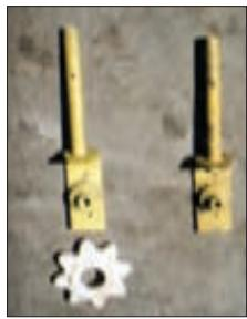
شکل ۲۱- قطعات زنجیر سفت کن
