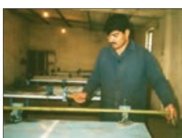
شکل ۱۱- صاف کردن محور انگشتی
