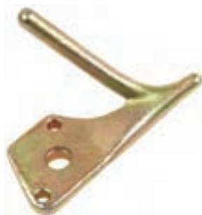
**۲- خرابی هادی نخ:** هادی نخ در صورت تماس با ماسوره نخ و قلاب گرهزن به مرور ساییده می‌شود (شکل ۳۸). همچنین اگر لبه هادی نخ با قلاب گرهزن یا ماسوره نخ برخورد کند ممکن است کج شود. در صورت وجود این اشکال‌ها نخ پس از گره زدن پاره می‌شود.
