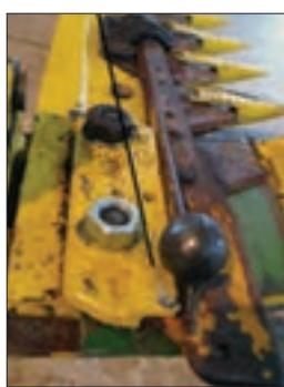
شکل ۶۳- تنظیم لقی سر شانه برش
