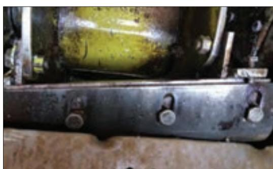
شکل ۴۴-پیچ و شیارهای رگلاژ تیغه متحرک
