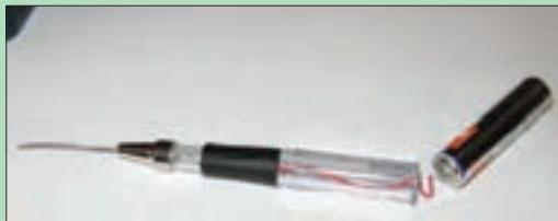
۳- یک پایه لامپ LED را به وسیله سیم به سر مشبک باتری متصل کنید و پایه دیگر آن را به یک سیم مفتولی نازک متصل کنید. سپس سیم مفتولی را از نوک خودکار خارج کنید.
