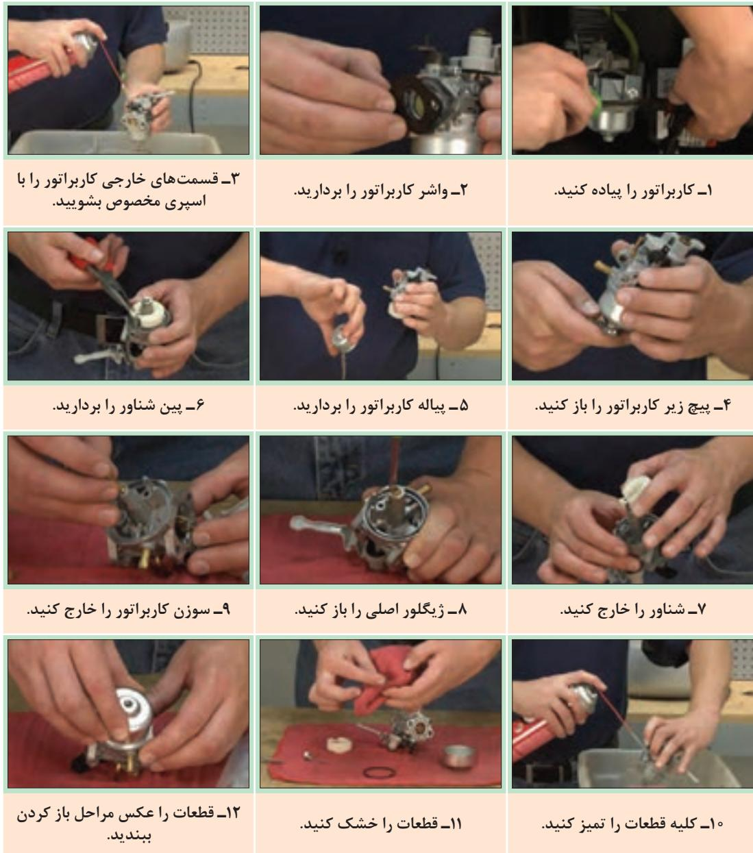
شکل ۲۵- باز کردن و تمیز کردن قطعات کاربراتور
