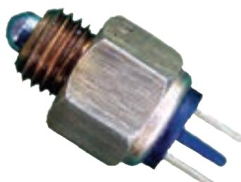
شکل ۵۶- سوئیچ دنده عقب
