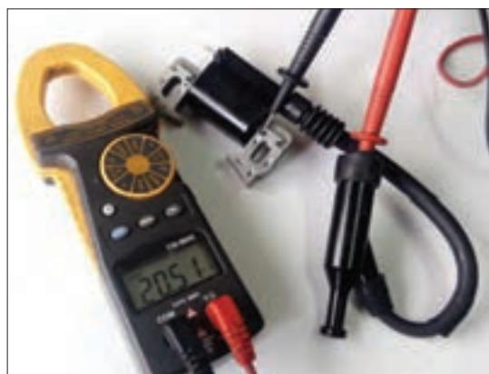
الف) مقاومت سیم پیچ ثانویه بین بدن کویل و سر شمع حدوداً ۲۵ کیلو اهم
