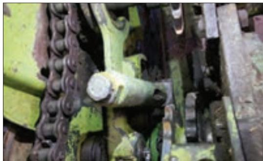
شکل ۴۳-اهرم و پیچ تنظیم تیغه ثابت
