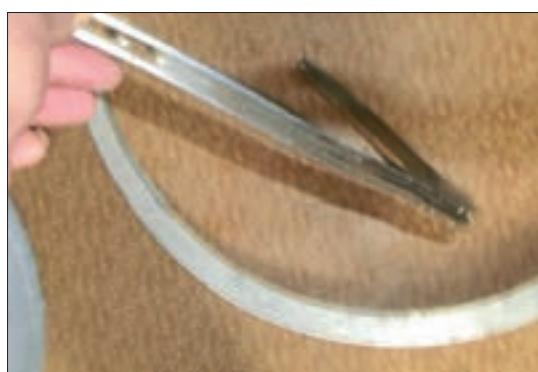
شکل ۵۸-سوزن خم شده
