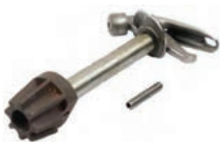
شکل ۳۹- قلاب گرهزن و چرخ دنده آن
