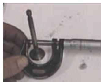
شکل ۲۹-۳۰- اندازه گیری سوپاپ
