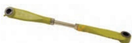
شکل ۶۲-میله رابط و یاتاقان‌های آن
