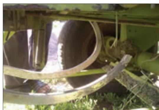
شکل ۵۷-سوزن شکسته
