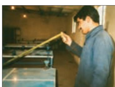
شکل ۱۰- آزمایش کجی محور انگشتی
