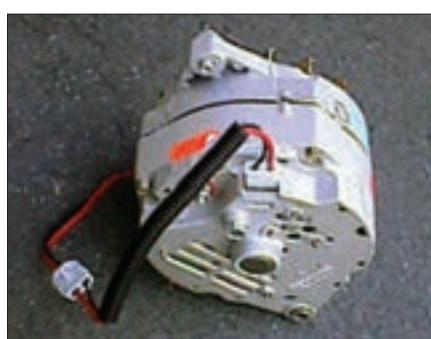
شکل ۱۸- آلترا ناتور مجهز به آفتمات الکترونیکی
