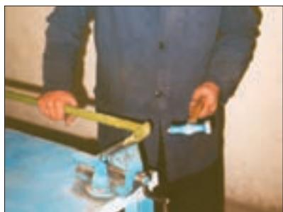
شکل ۱۵- صاف کردن پایه بلبرینگ
