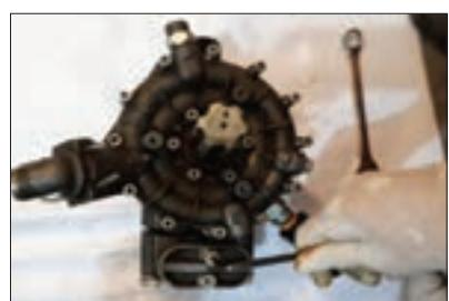
شکل ۴۸ - باز کردن درپوش سوپاپ ها
