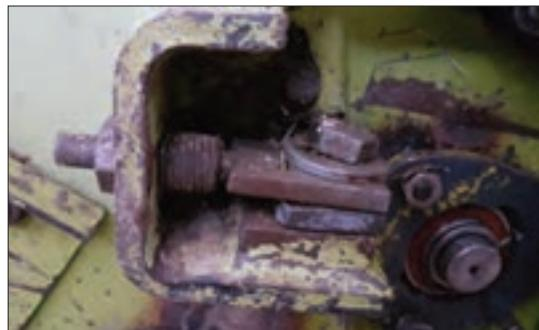
شکل ۴۲-پیچ تنظیم تیغه ثابت
