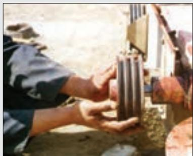
شکل ۱۱- برداشتن چرخ تسمه
