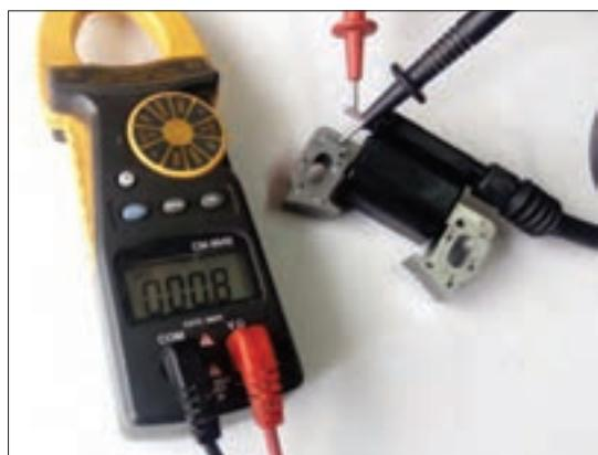
ب) مقاومت سیم پیچ اولیه (سیم متصل به سوئیچ) و بدن کویل حدوداً ۰.۸ اهم
