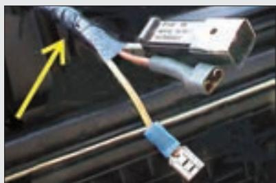
شکل ۲۳- عایق‌بندی اتصالات
