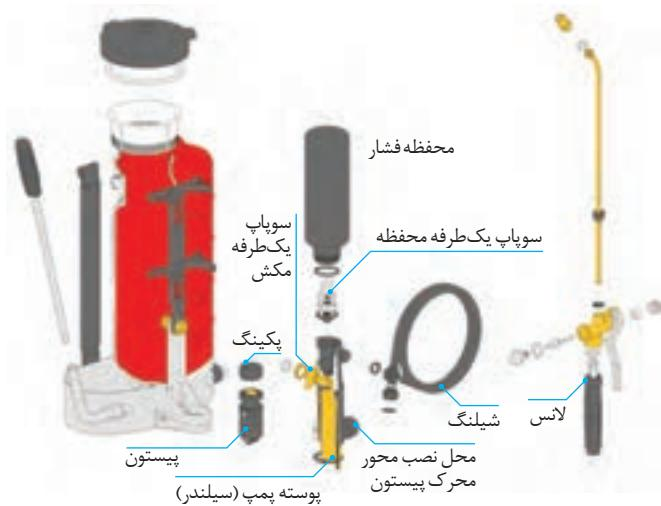
شکل ۳۷- پمپ پیستونی دستی در سم‌پاش پشتی
