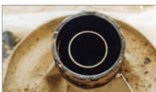
شکل ۴۳- ساییدگی جای بلبرینگ
