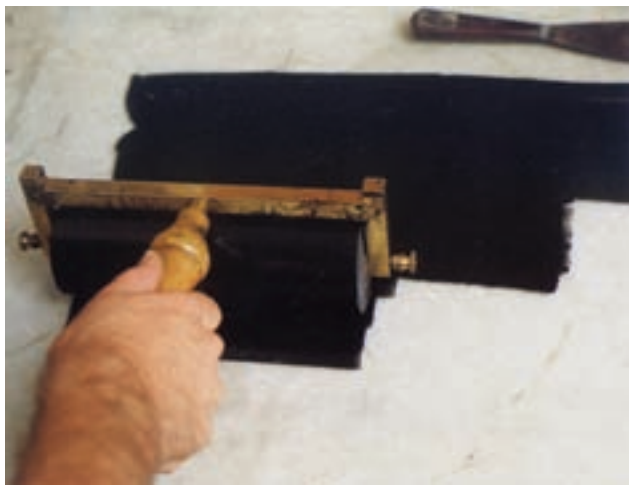
تصویر ۶۰- پخش کردن مرکب روی سطح شیشه
