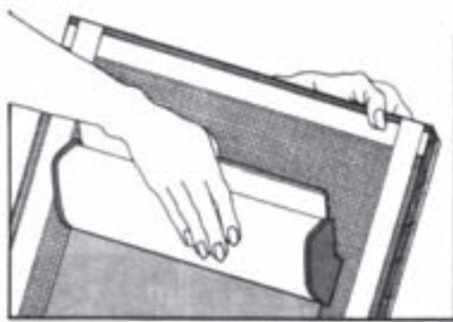
تصویر ۱۲۲- طرز کشیدن ماده حساس روی توری
