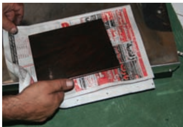
تصویر ۱۸۲- لازم است کلیشه در دو مرحله (قبل از مرکب زدن و پس از پاک کردن مرکب‌های اضافه یعنی درست قبل از چاپ) روی هیتر گذاشته شده و گرم شود.
