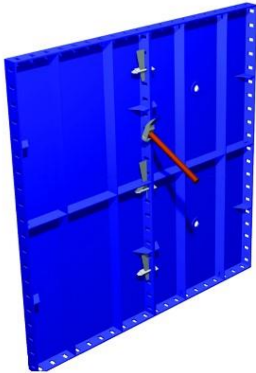
استفاده از گوه نر و مادگی برای اتصال پنل‌های مدولار
