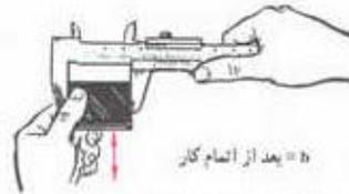
شکل ۱۲-۴- اندازه‌گیری خارجی با کولیس
