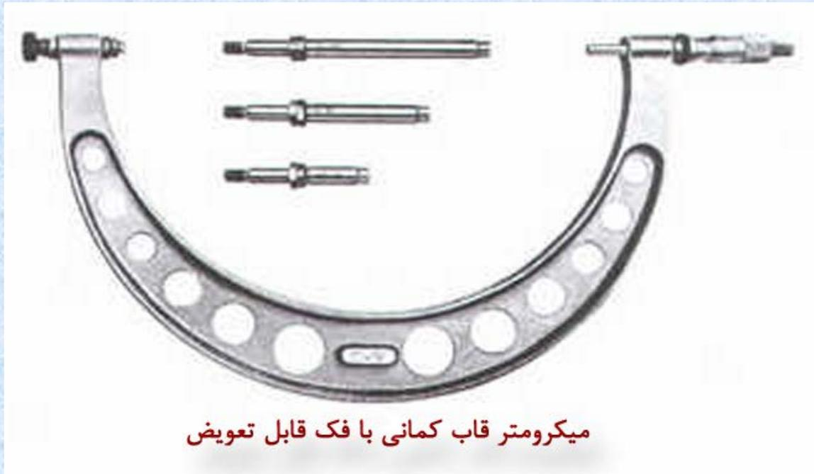
میکرومتر قاب کمانی با فک قابل تعویض
