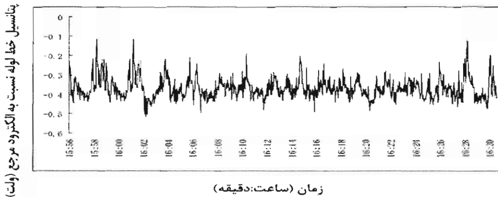
شکل ۲: تغییرات پتانسیل لوله مدفون نسبت به الکتروود مرجع \text{Cu}/\text{CuSO}_4 در متروی شاکتهای (۸).
