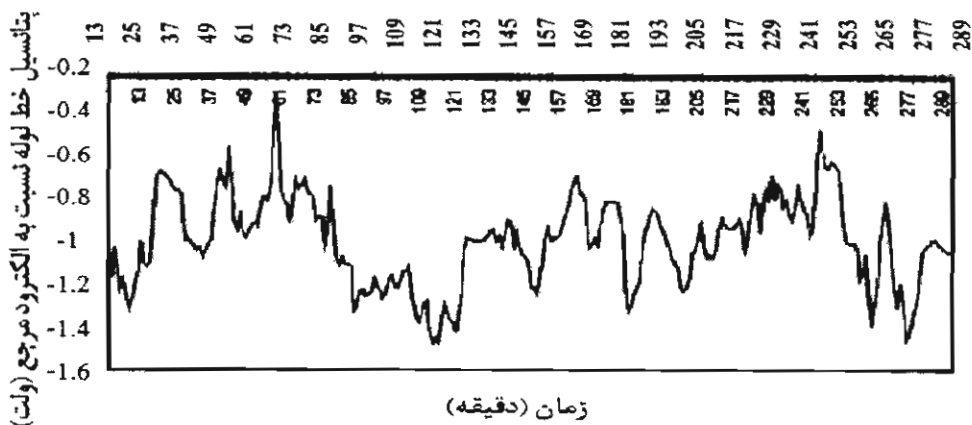
شکل ۳: تغییرات پتانسیل لوله نسبت به خاک تحت تاثیر جریان سرگردان مترو در ایلینوی آمریکا [۱۱].
