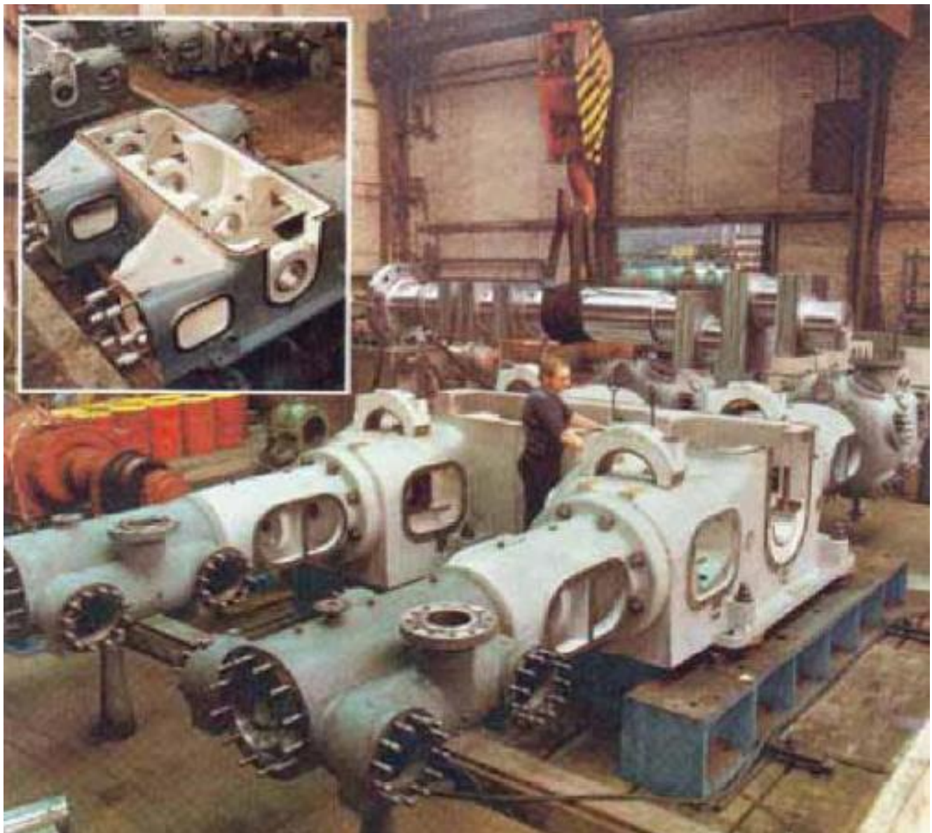
مقطعی از محفظه میل لنگ یک کمپرسور رفت و برگشتی
