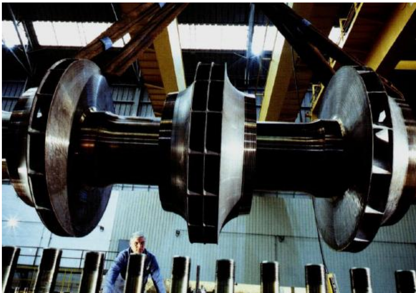
شکل ۲۹- نمایی از یک روتور یا شفتی که لوازم متحرک بر روی آن نصب شده‌اند.
