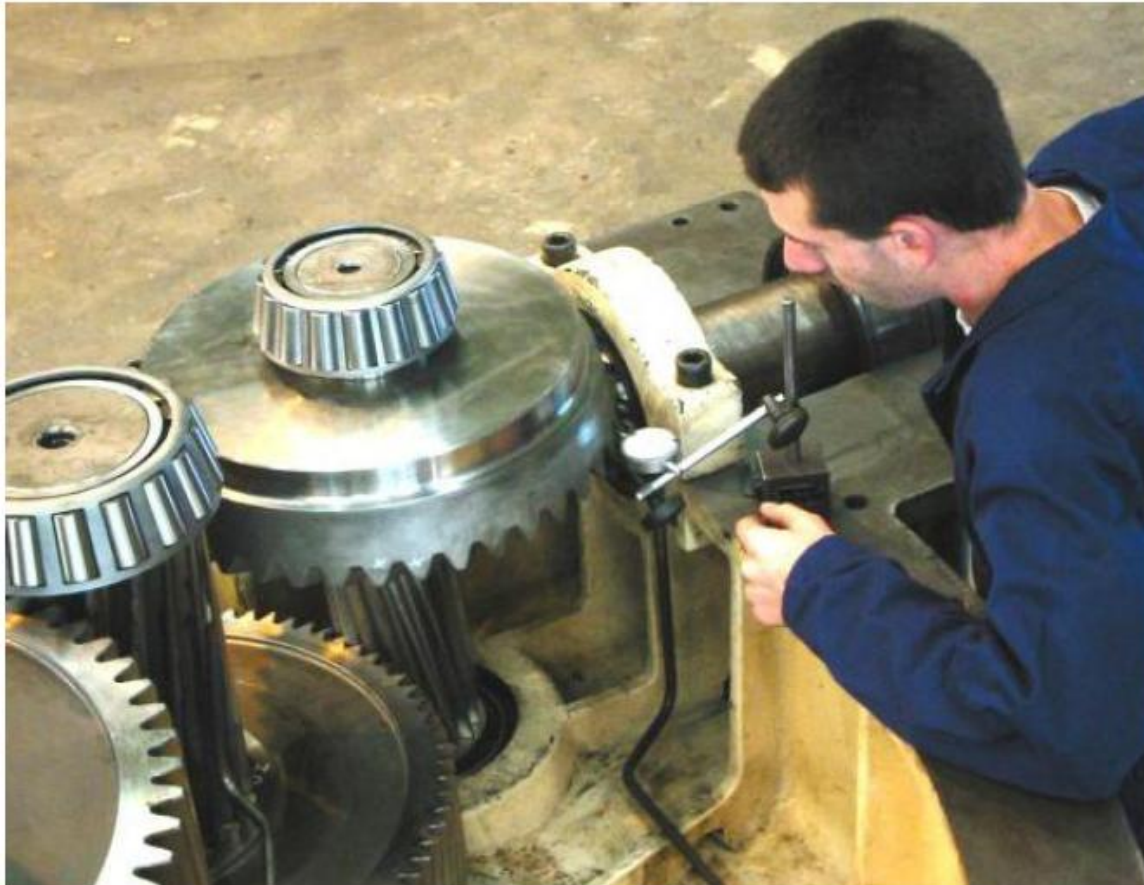
شکل ۳۲- نمایی از قسمت‌های داخلی جعبه دنده
