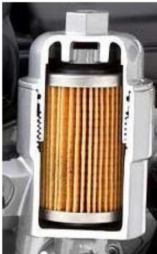
شکل ۳۸- نمونه ای از یک فیلتر روغن در کمپرسورها که درون محفظه خود قرار دارد
