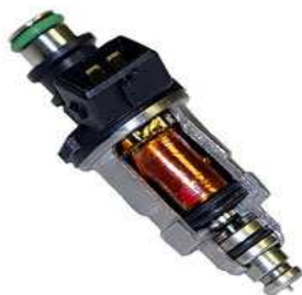
شکل (۳-۲۸) عملگر انژکتور
