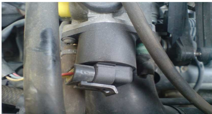
شکل (۳-۲۶) عملگر استپر موتور
