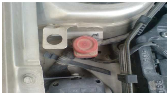
شکل (۲۰-۳) عملگر سوئیچ اینرسی
