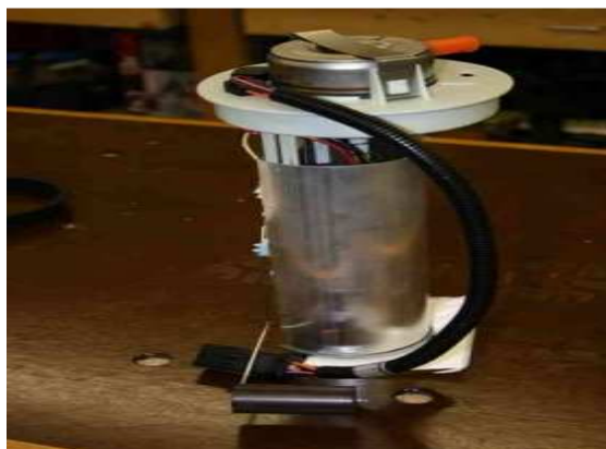
شکل (۳-۲۴) عملگر پمپ بنزین
