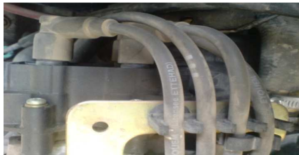
شکل (۳-۲۲) عملگر کوئل دوبل
