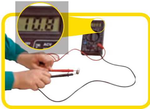
شکل ۸- اندازه‌گیری مقاومت لامپ خاموش با اهم متر
