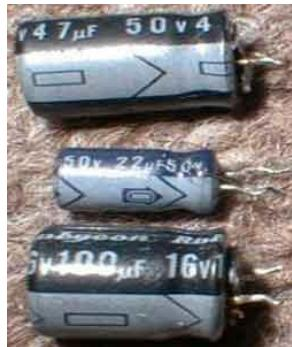
**نکته‌ی مهم:** همان طور که می‌بینید روی بدنه‌ی خازن‌های الکترولیت، یک نوار کشیده شده که به وسیله‌ی آن پایه‌ی - مشخص شده، در این خازن‌های اگر جای + و - را اشتباه وصل کنیم در اثر پدیده‌ی فروشکست خازن می‌ترکد! در خازن‌های الکترولیتی نیز، خازن ذوب می‌شود!
