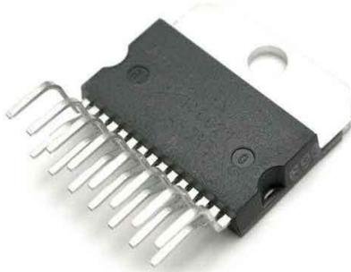
همان طور که در شکل می بینید، یک قطعه فلز در پشت این IC تعبیه شده تا از با انتقال گرما از IC به محیط، مانع گرم شدن بیش از حد IC شود. این قطعه Heat sink نام دارد. گاهی برای اطمینان بیشتر از یک Heat sink کمکی نیز استفاده می کنیم، به این صورت که Heat sink خود IC به وسیله ی پیچ به Heat sink خود می شود.
