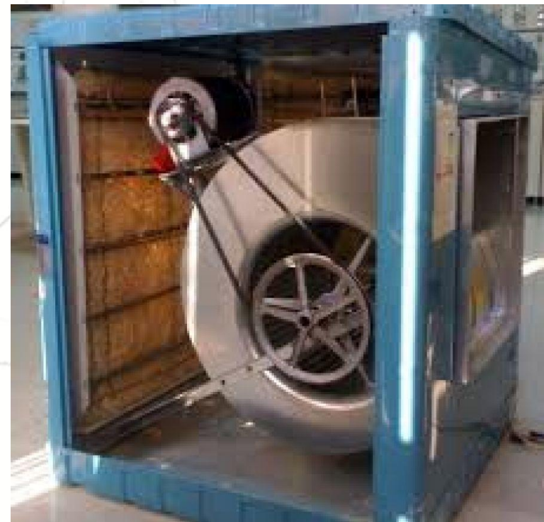
کولر آبی با موتور القایی تکفاز با راندمان کمتر از ۵۰ درصد
