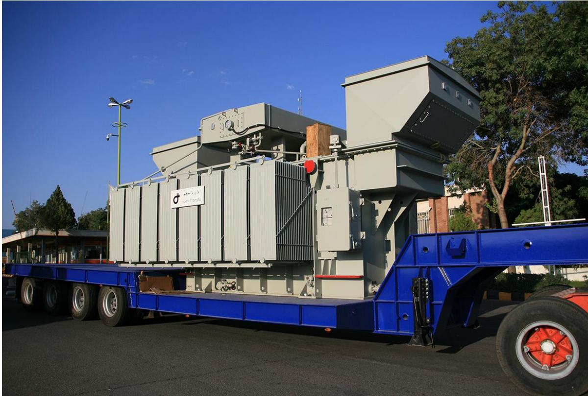
ترانسفورماتور 200 MVA ساخت شرکت ایران ترانسفو
