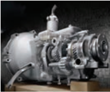
شکل ۱۵ - ترکیب پیچیده‌ای از چرخ‌دنده در جعبه‌دنده خودرو
