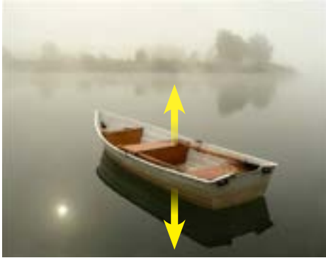
شکل ۵ - نیروی رو به بالایی که از طرف آب به قایق وارد می‌شود هم اندازه با وزن قایق است، بنابراین قایق روی آب به حالت تعادل باقی می‌ماند.
