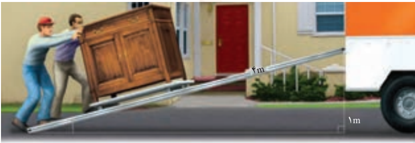
شکل ۱۷ – استفاده از سطح شیب‌دار جابه‌جایی جسم‌های سنگین را آسان می‌کند.
